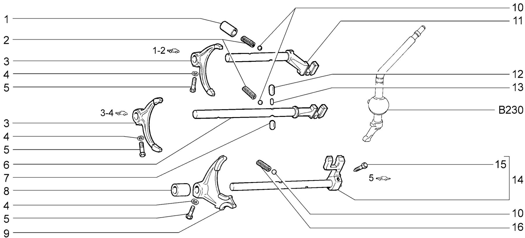
**МЕХАНИЗМ ПЕРЕКЛЮЧЕНИЯ ПЕРЕДАЧ**
