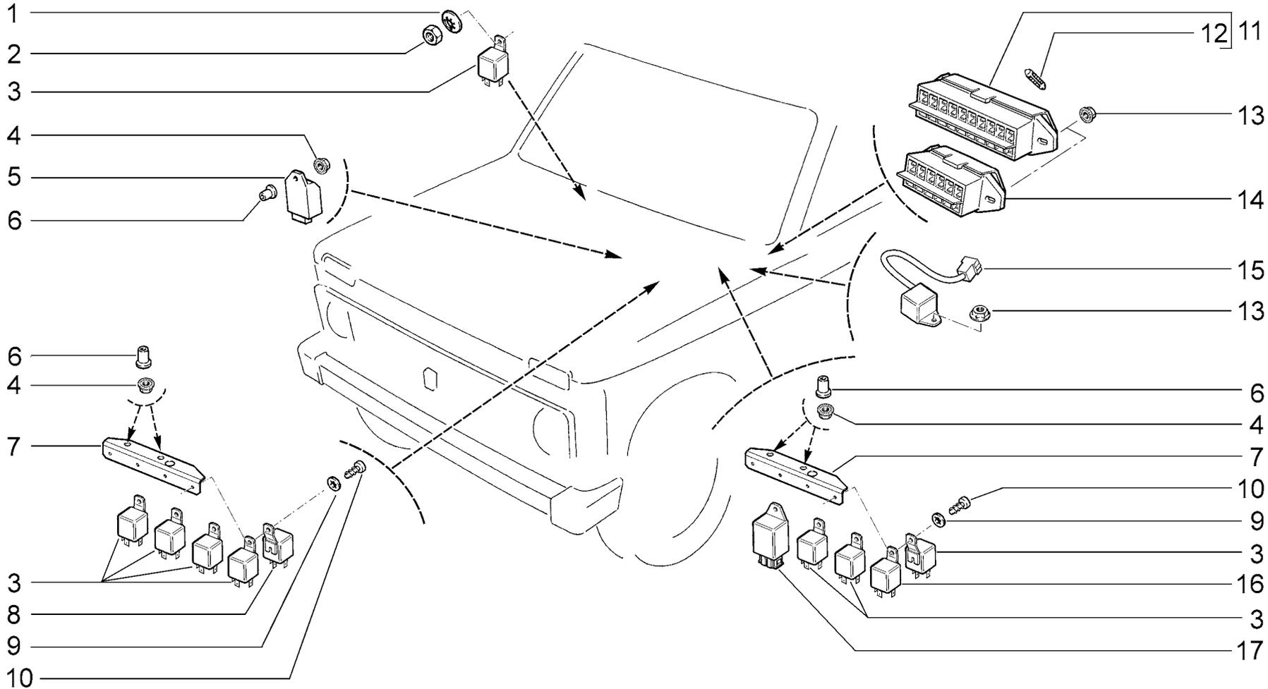
**РЕЛЕ И БЛОКИ ПРЕДОХРАНИТЕЛЕЙ**
