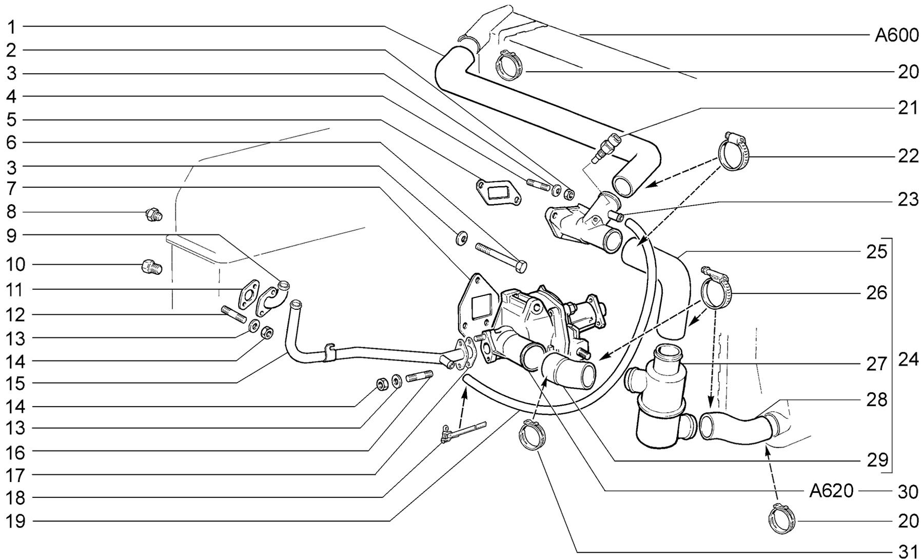
**НАСОС ВОДЯНОЙ И ТРУБОПРОВОДЫ**
