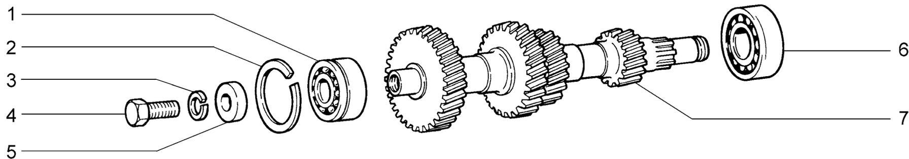
**ВАЛ ПРОМЕЖУТОЧНЫЙ КОРОБКИ ПЕРЕДАЧ**
