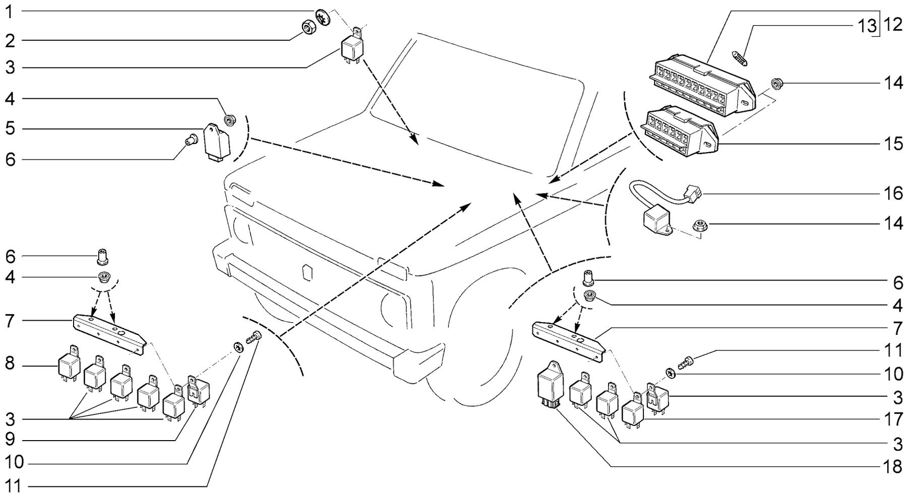
**РЕЛЕ И БЛОКИ ПРЕДОХРАНИТЕЛЕЙ**
