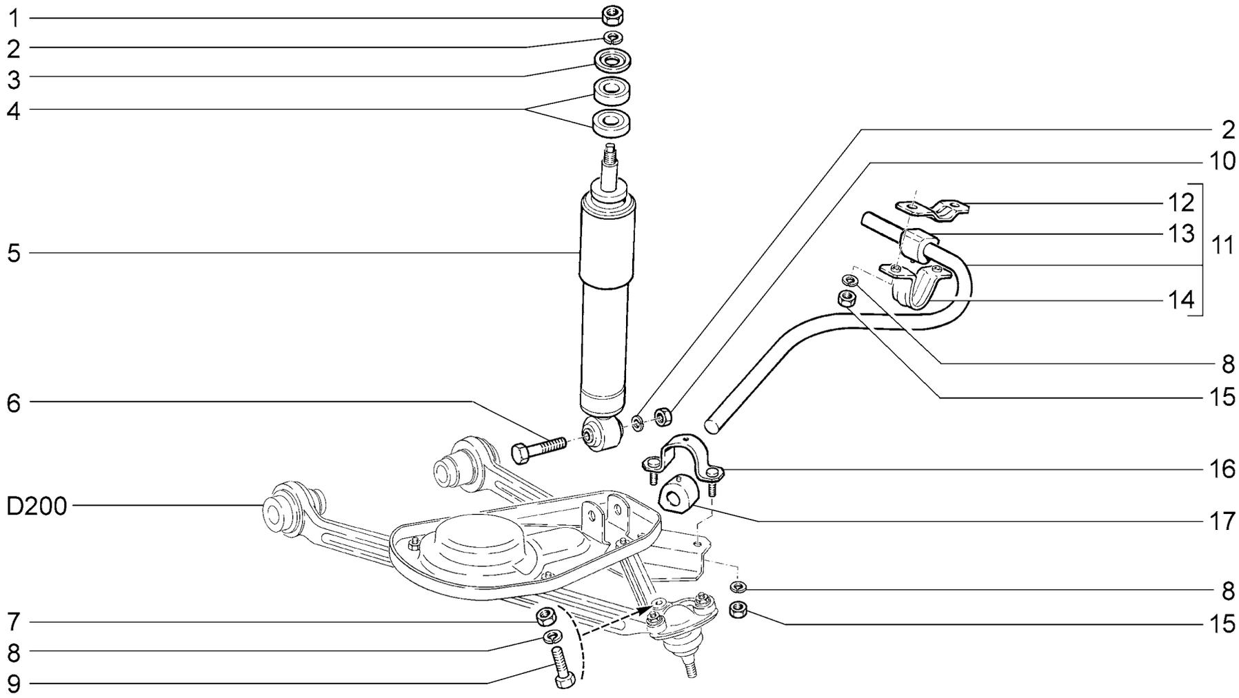
**АМОРТИЗАТОРЫ И СТАБИЛИЗАТОР ПОПЕРЕЧНОЙ УСТОЙЧИВОСТИ**
