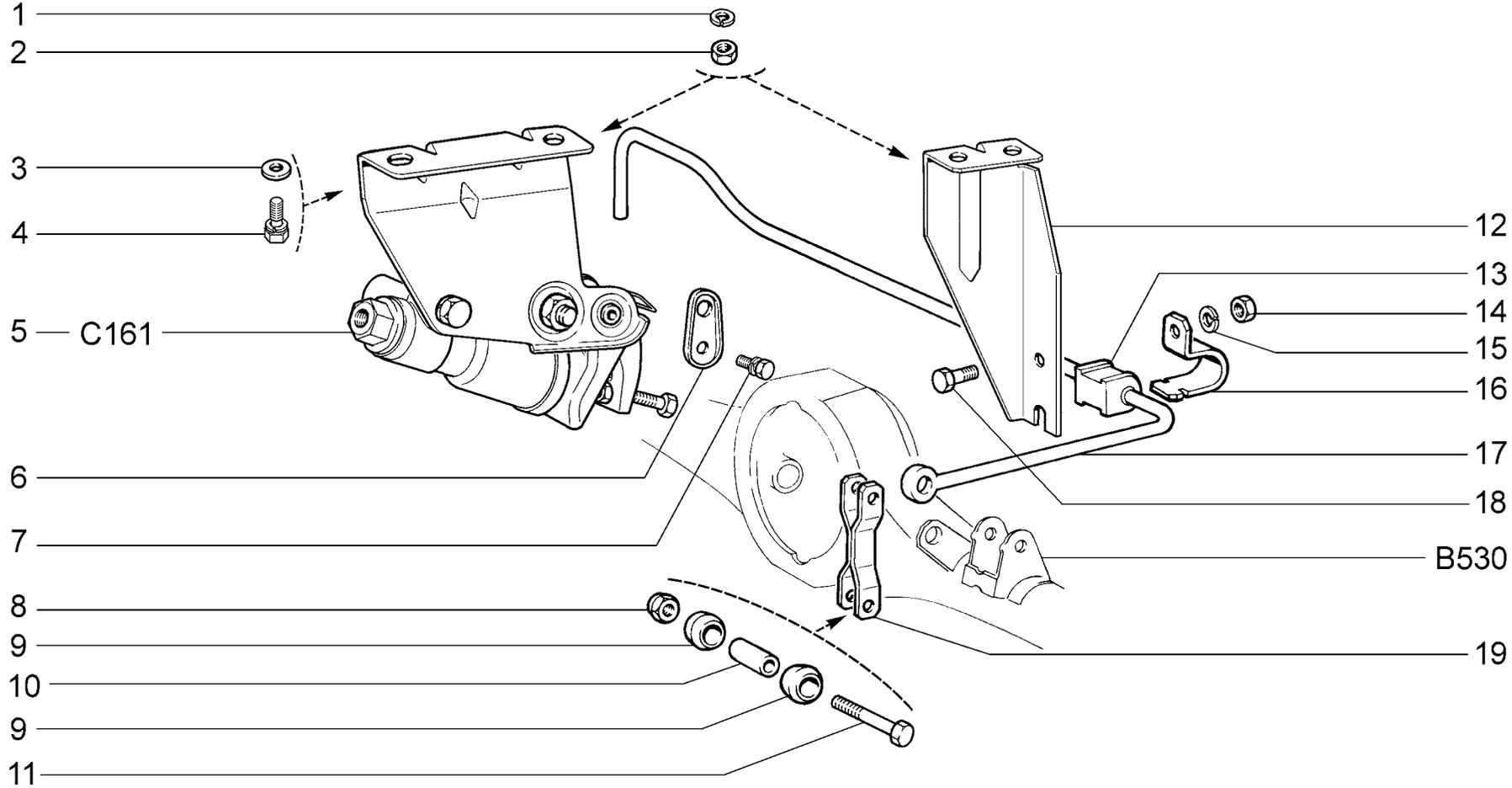
**ПРИВОД РЕГУЛЯТОРА ДАВЛЕНИЯ (BAS)**
