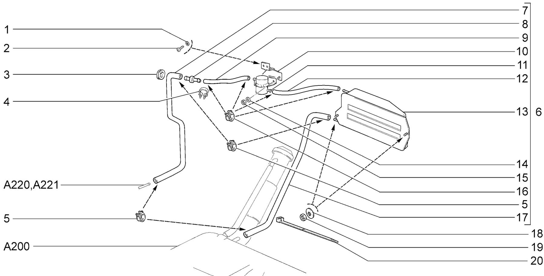
**СИСТЕМА УЛАВЛИВАНИЯ ПАРОВ БЕНЗИНА (СЕПАРАТОР)**
