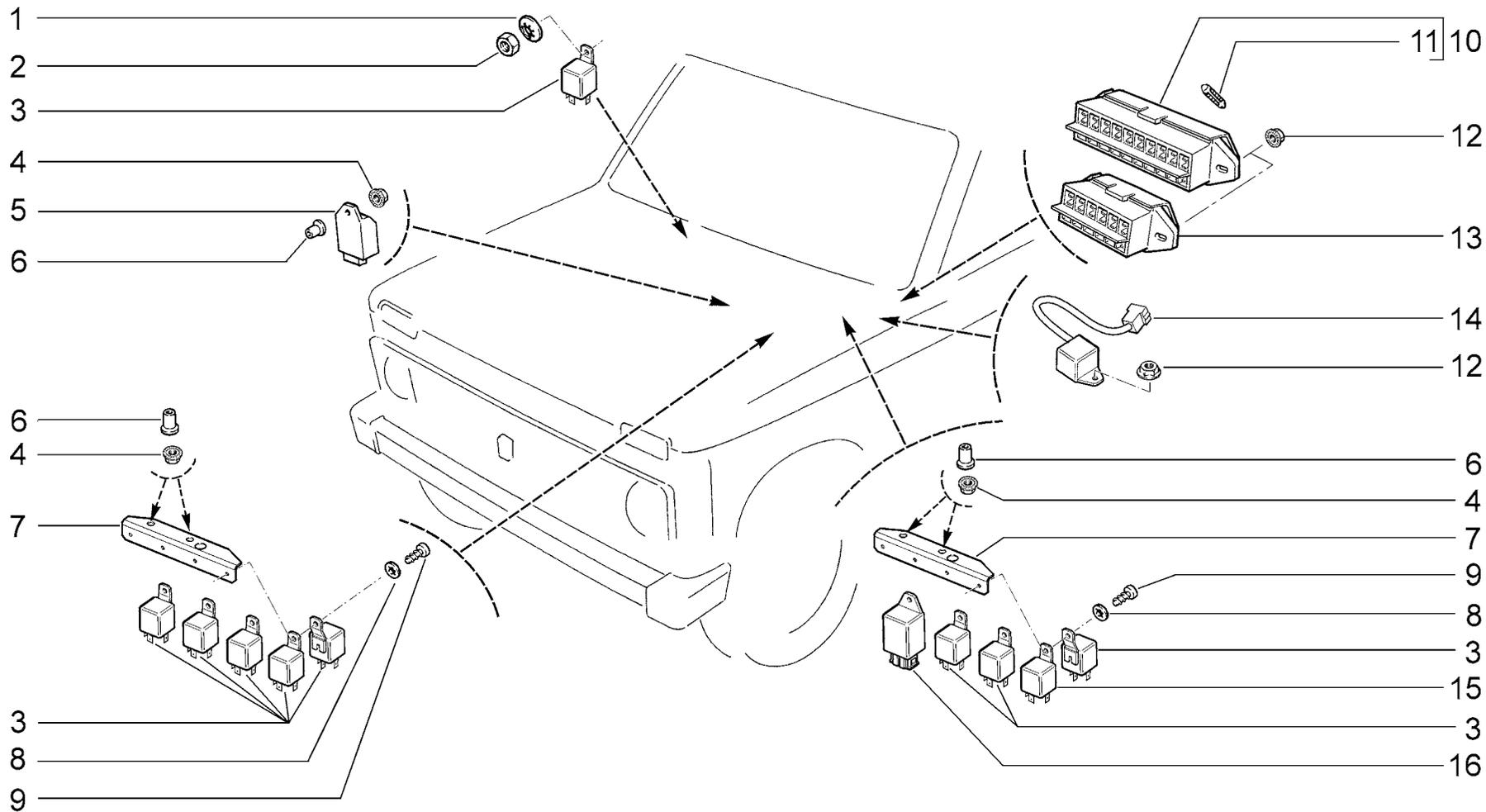
**РЕЛЕ И БЛОКИ ПРЕДОХРАНИТЕЛЕЙ**
