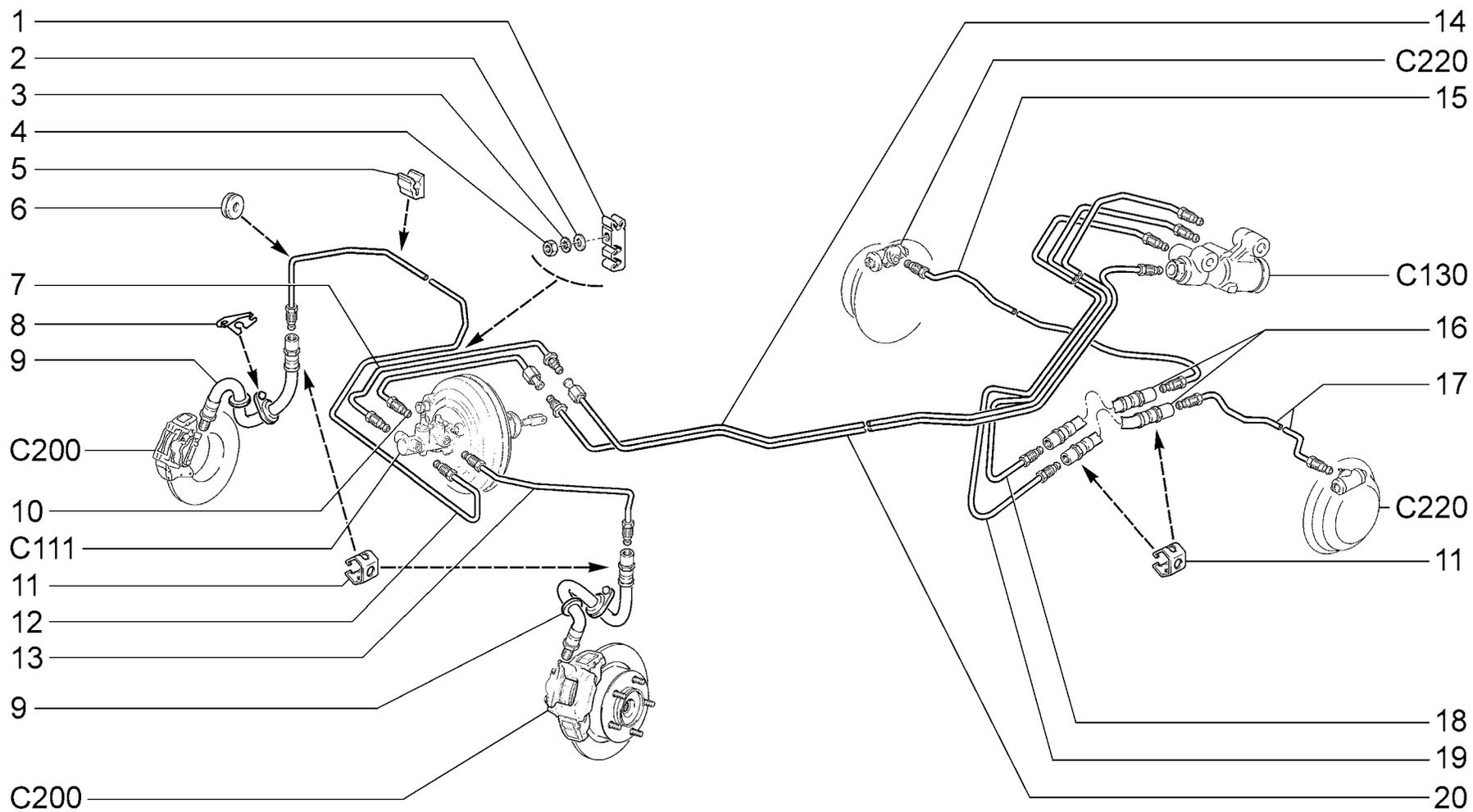
**ПРИВОД ГИДРОТОРМОЗОВ (BAS)**
