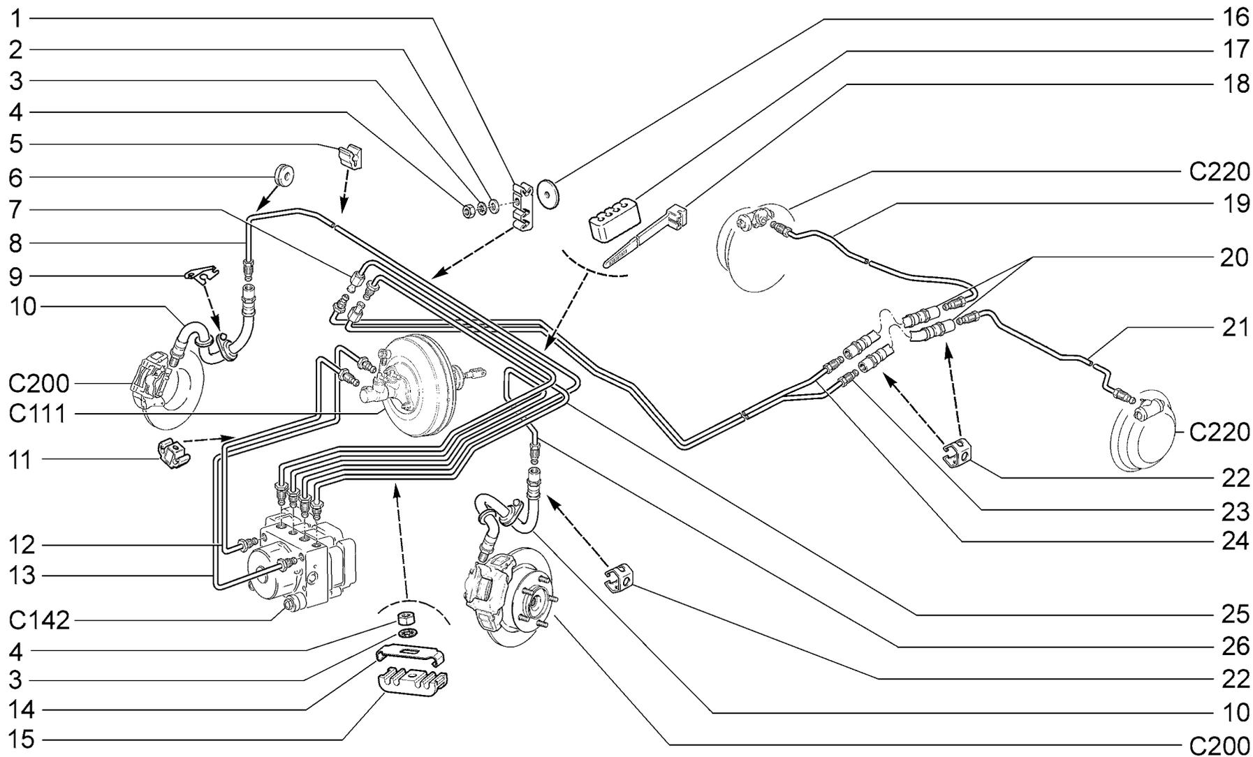
**ПРИВОД ГИДРОТОРМОЗОВ (BAS) (АБС)**
