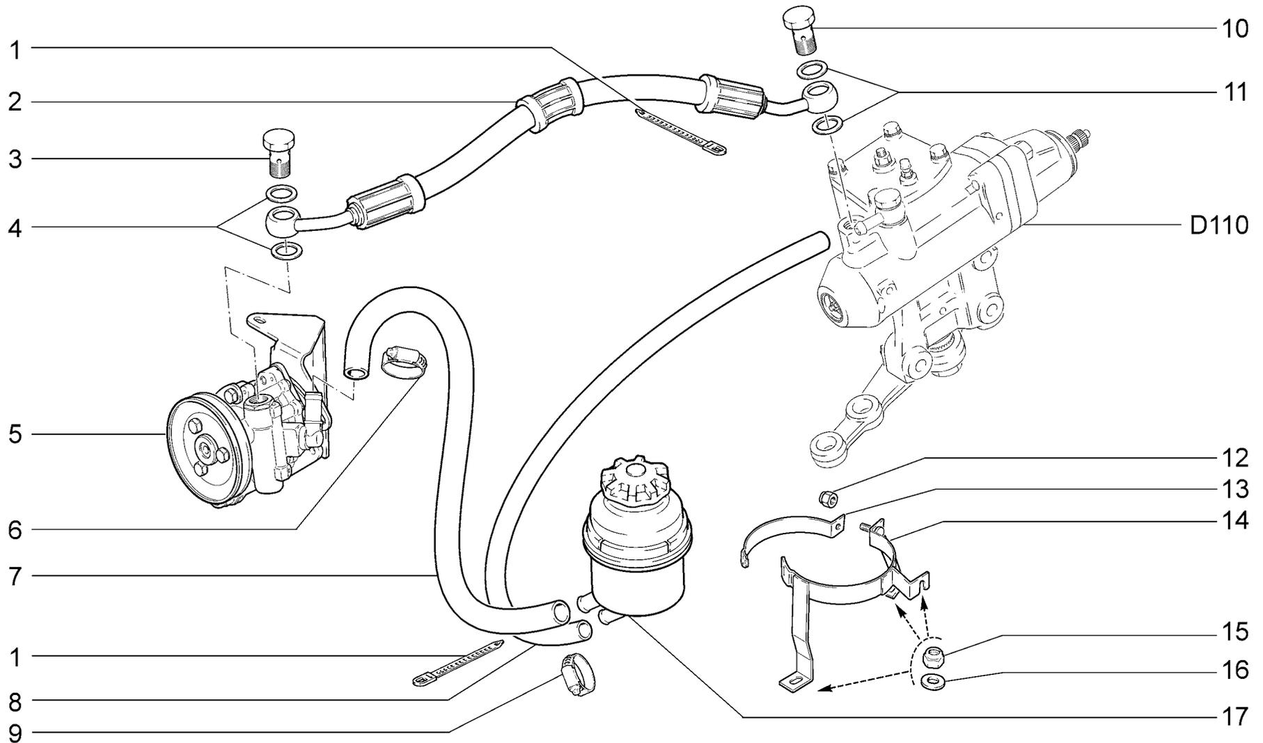
**СИСТЕМА ГИДРОУСИЛИТЕЛЯ РУЛЕВОГО УПРАВЛЕНИЯ (BAS)**
