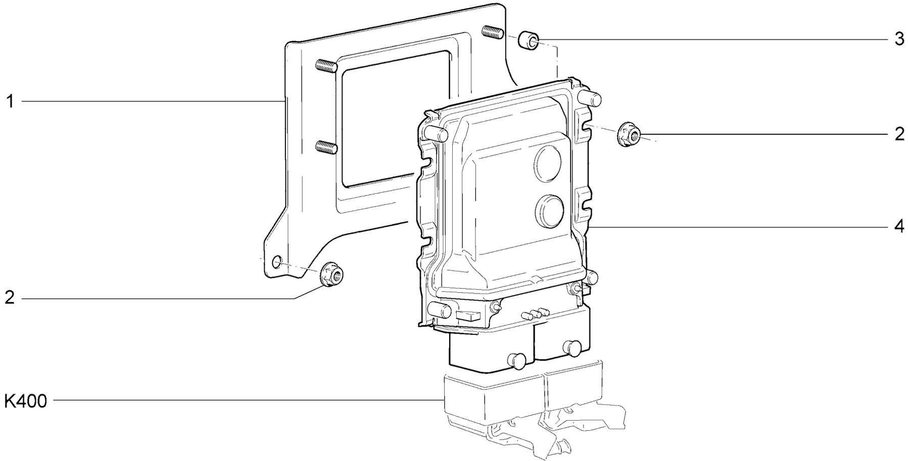
**КОНТРОЛЛЕР СИСТЕМЫ УПРАВЛЕНИЯ ДВИГАТЕЛЕМ**
