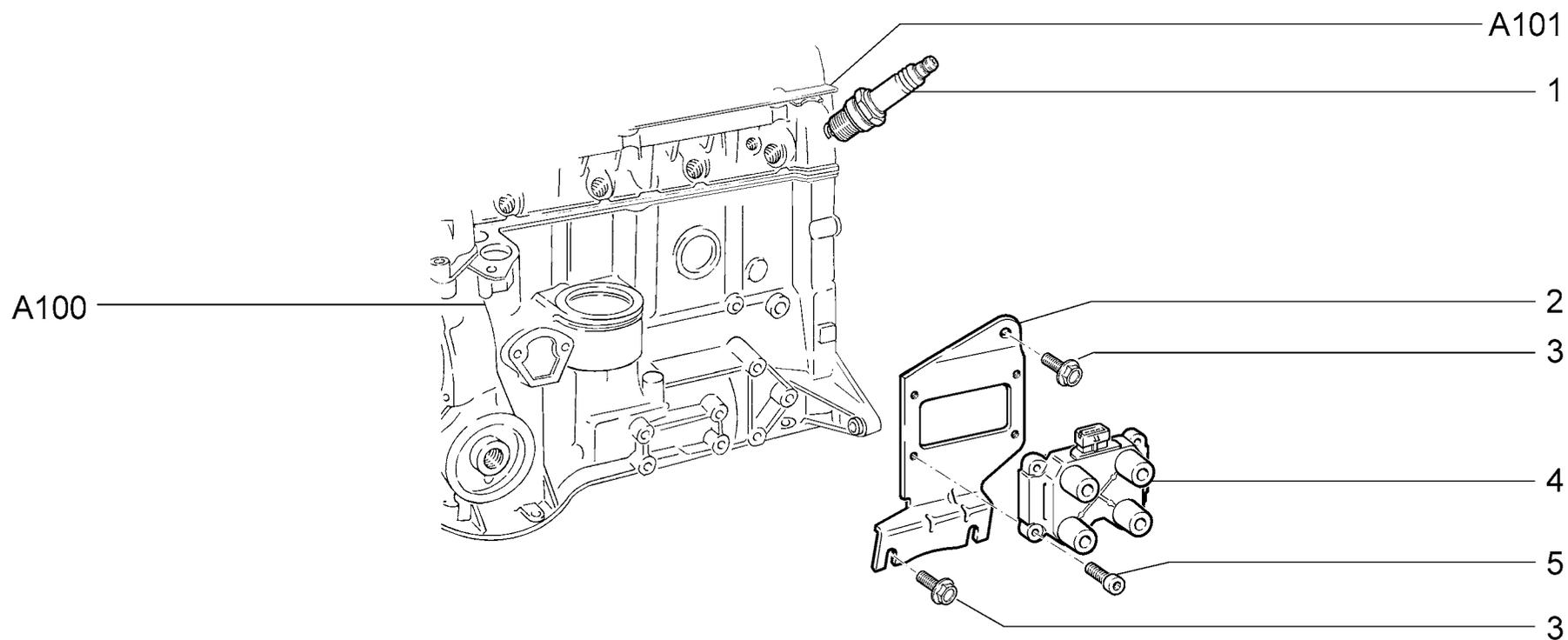
**МОДУЛЬ И СВЕЧИ ЗАЖИГАНИЯ**
