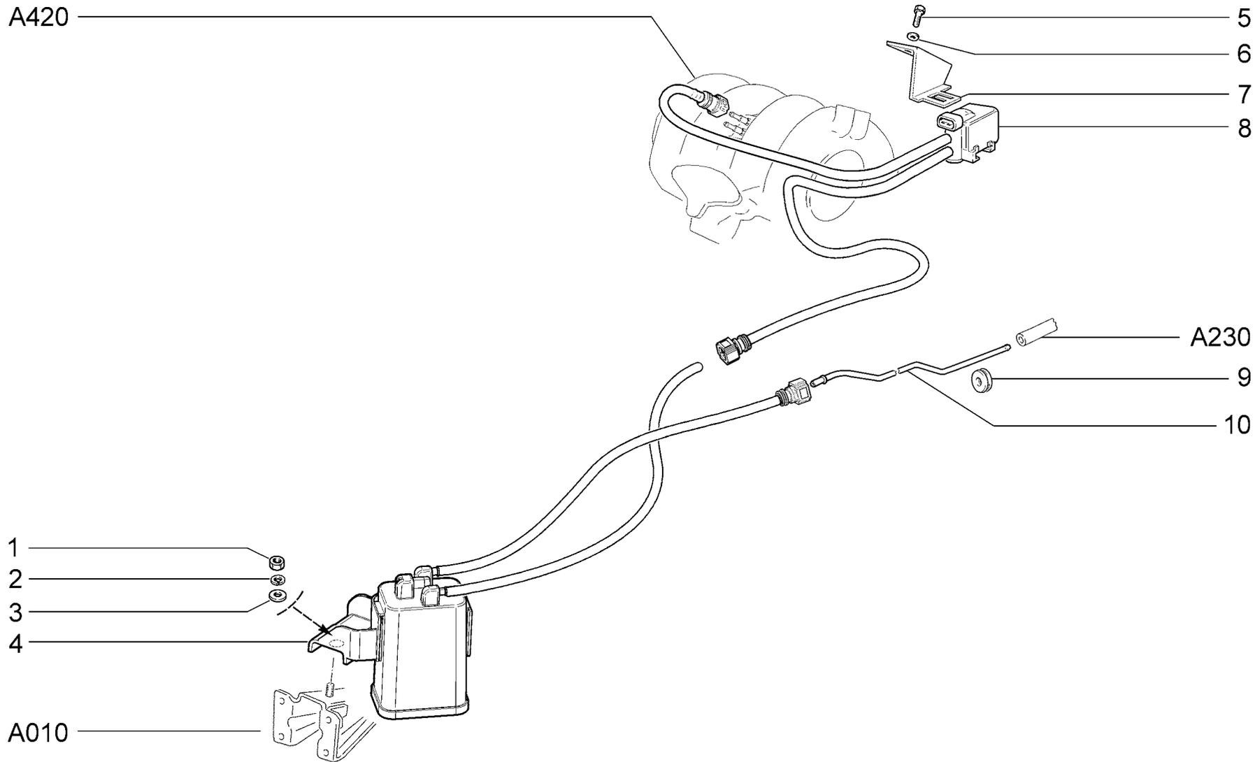
**СИСТЕМА УЛАВЛИВАНИЯ ПАРОВ БЕНЗИНА (АДСОРБЕР)**
