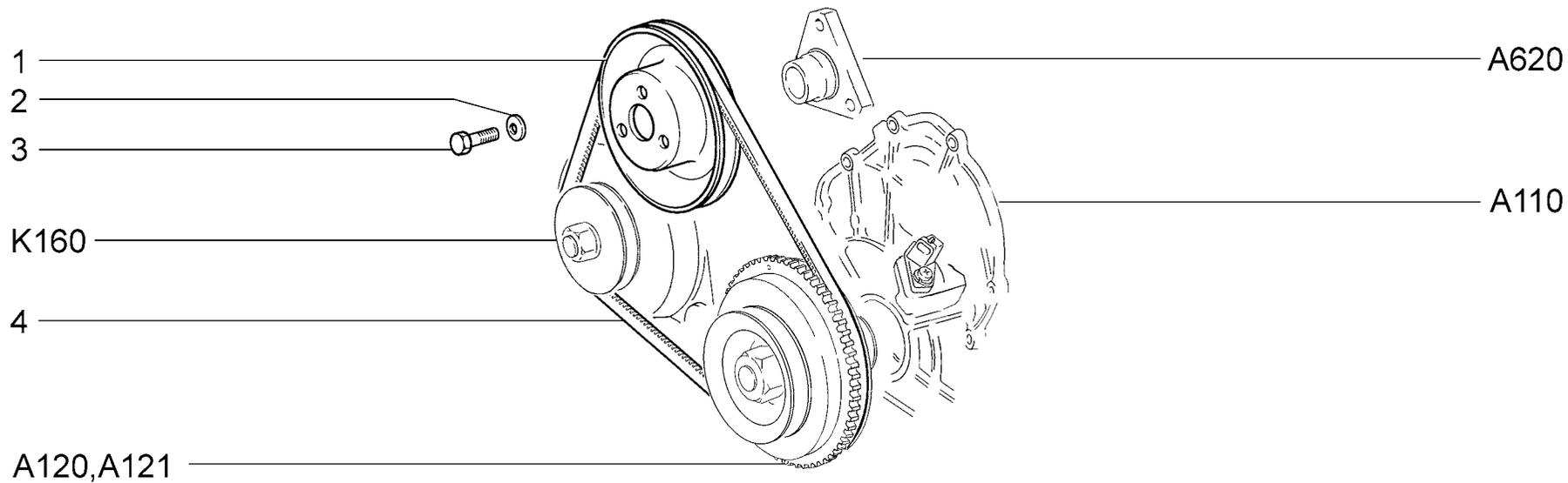
**ПРИВОД ВОДЯНОГО НАСОСА**
