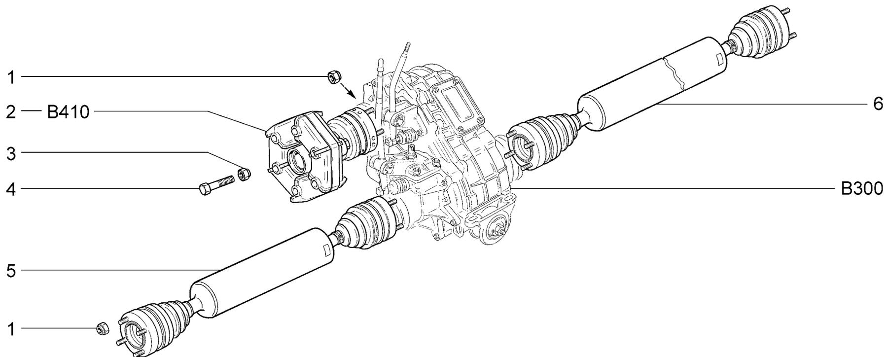
**ПРИВОД РАЗДАТОЧНОЙ КОРОБКИ И МОСТОВ**
