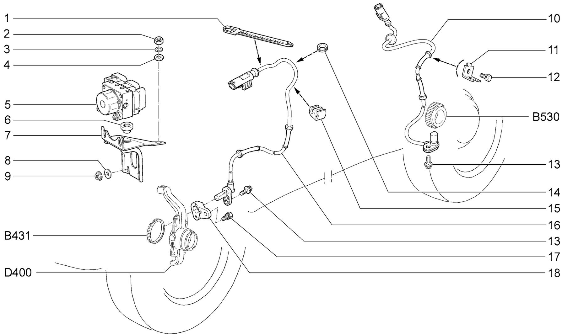
**ГИДРОАГРЕГАТ И ДАТЧИКИ СКОРОСТИ КОЛЁС (BAS) (АБС)**
