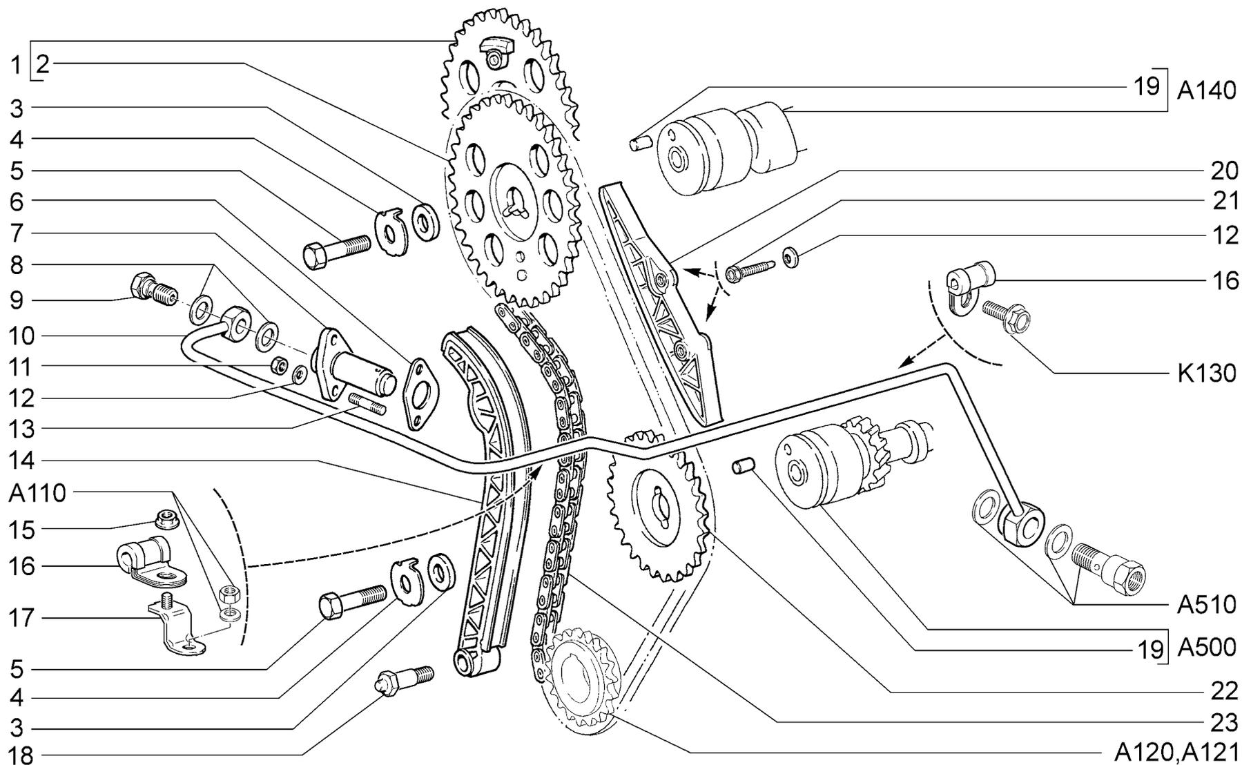
**ПРИВОД ВАЛА РАСПРЕДЕЛИТЕЛЬНОГО**
