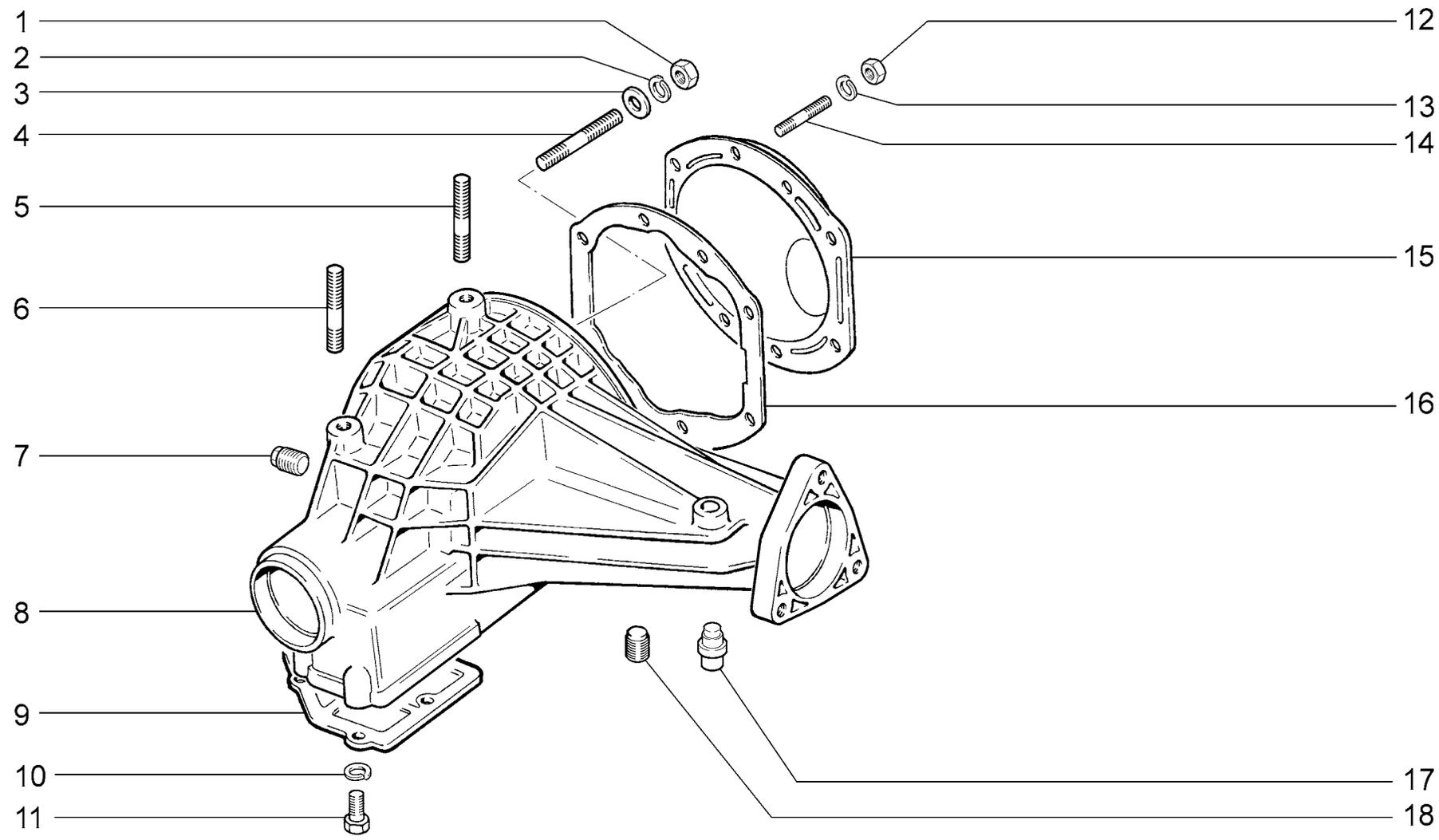
**КОРПУС И КРЫШКИ РЕДУКТОРА**
