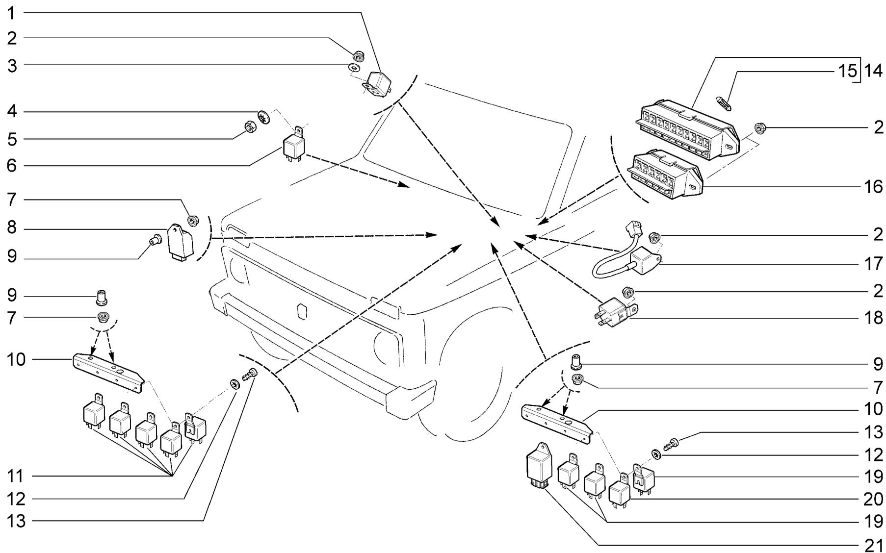
Реле и блоки предохранителей
