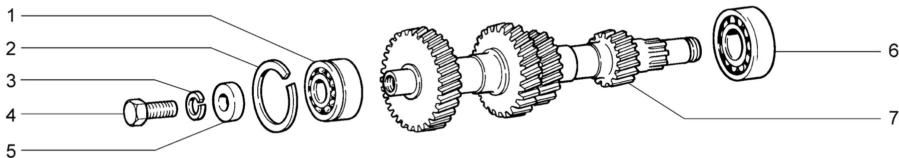
**Вал промежуточный коробки передач**
