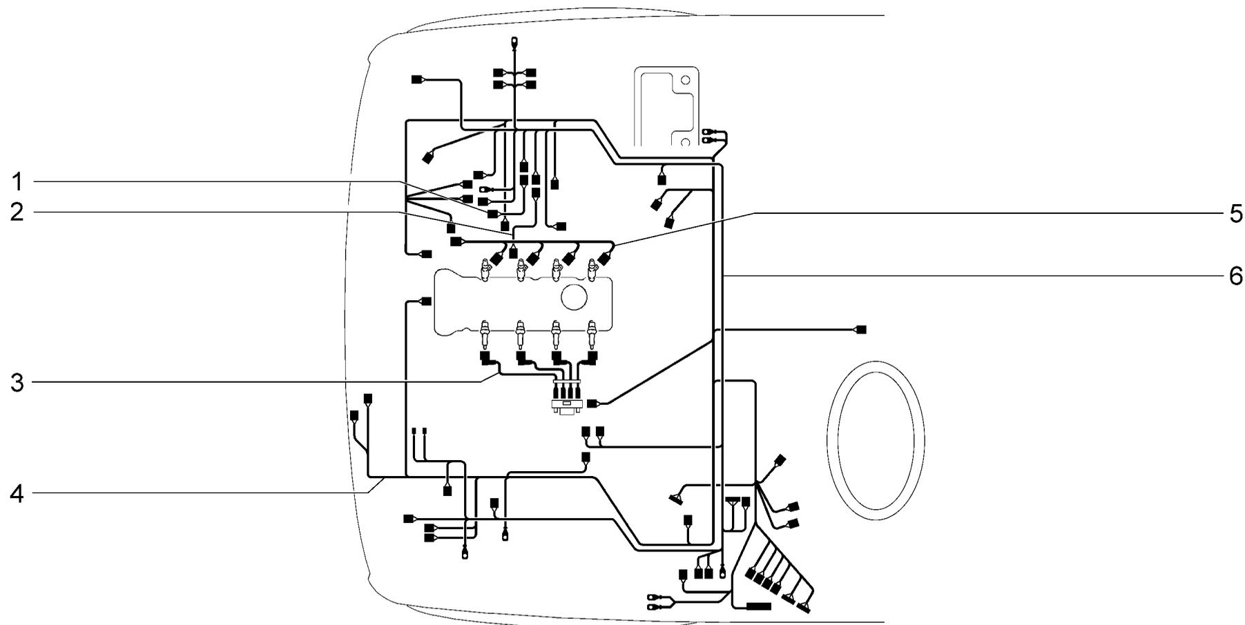
**Жгут проводов моторного отсека**
