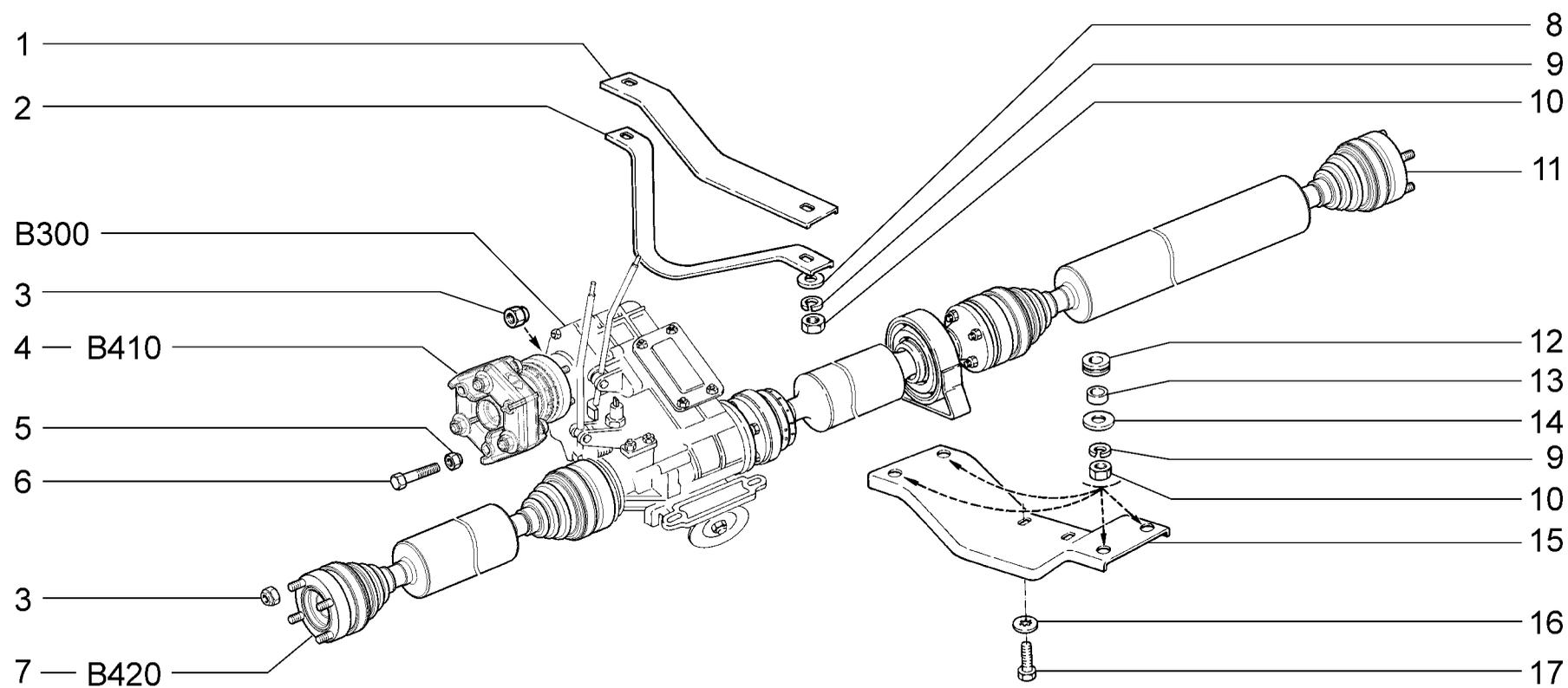
Привод раздаточной коробки и мостов
