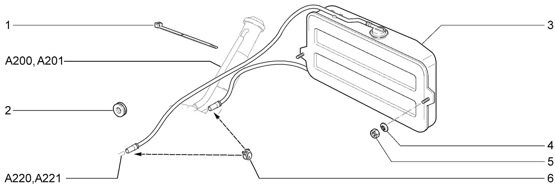
**Система улавливания паров бензина (Сепаратор)**
