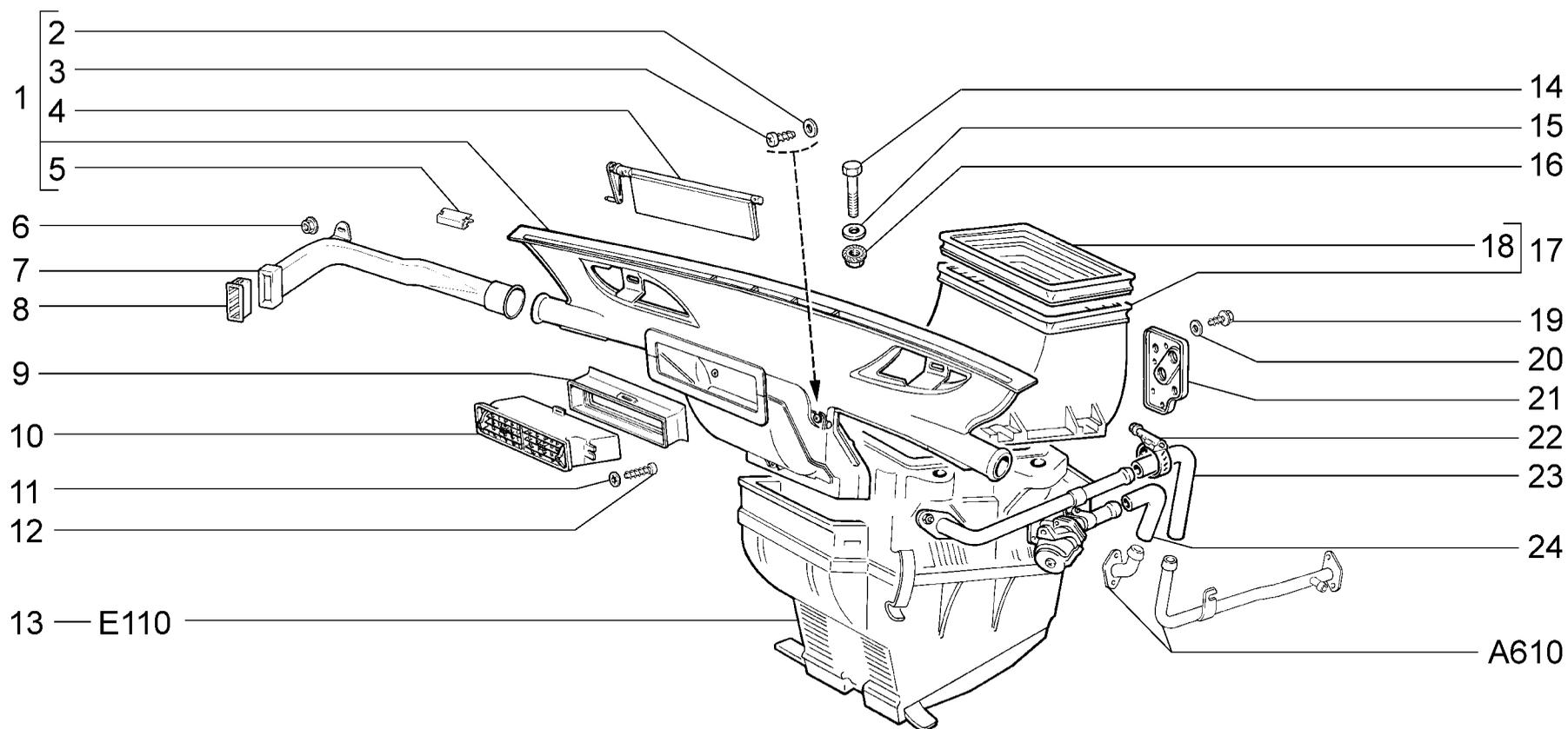
**Система вентиляции и отопления**
