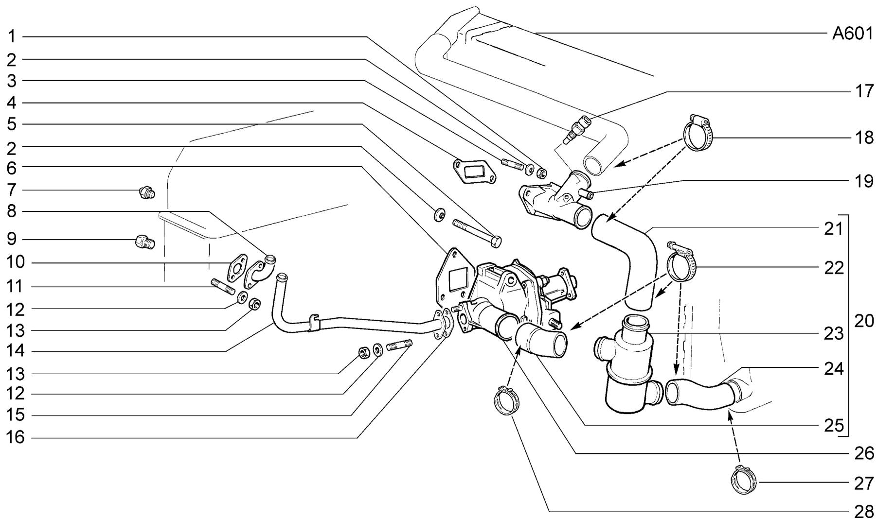
**Насос водяной и трубопроводы**
