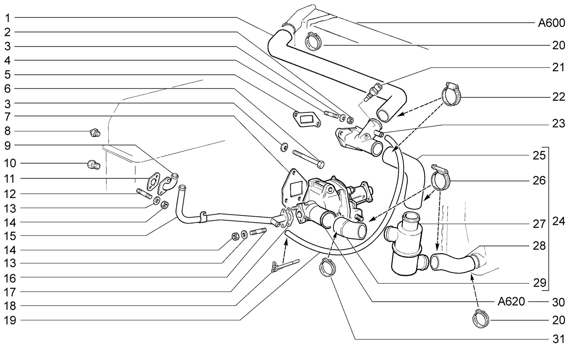
**Насос водяной и трубопроводы**
