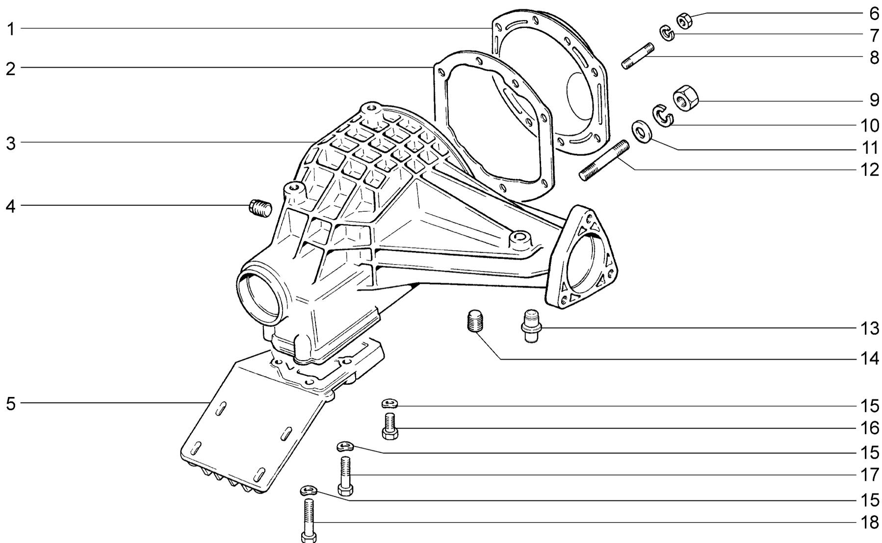
**Корпус и крышки редуктора**
