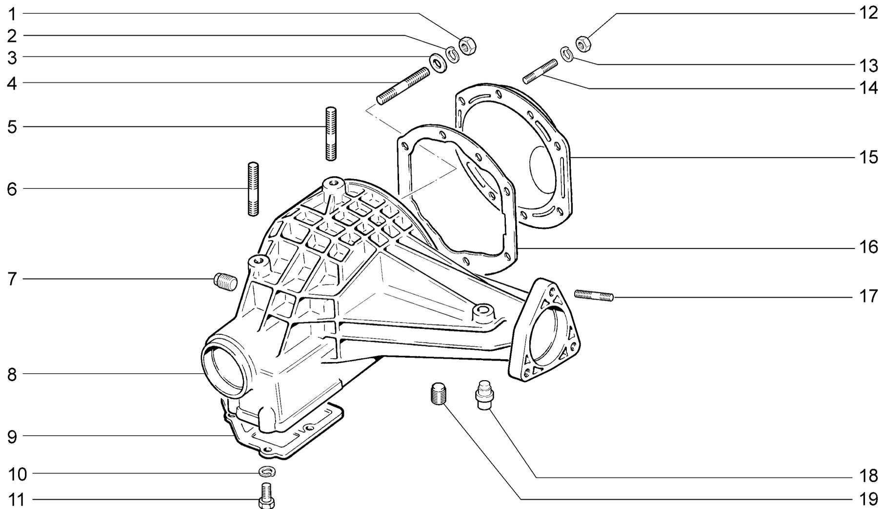
Корпус и крышки редуктора
