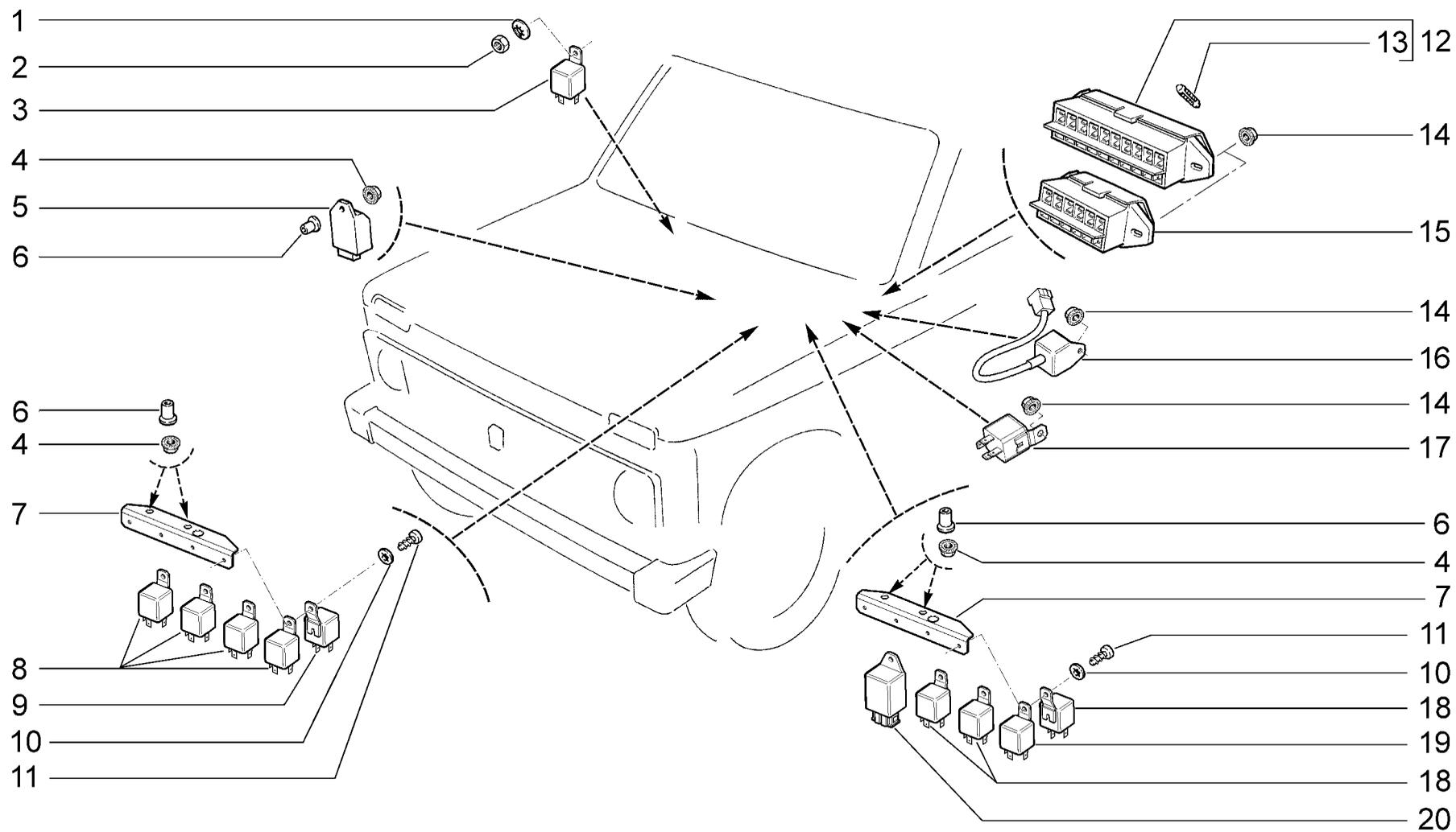
Реле и блоки предохранителей
