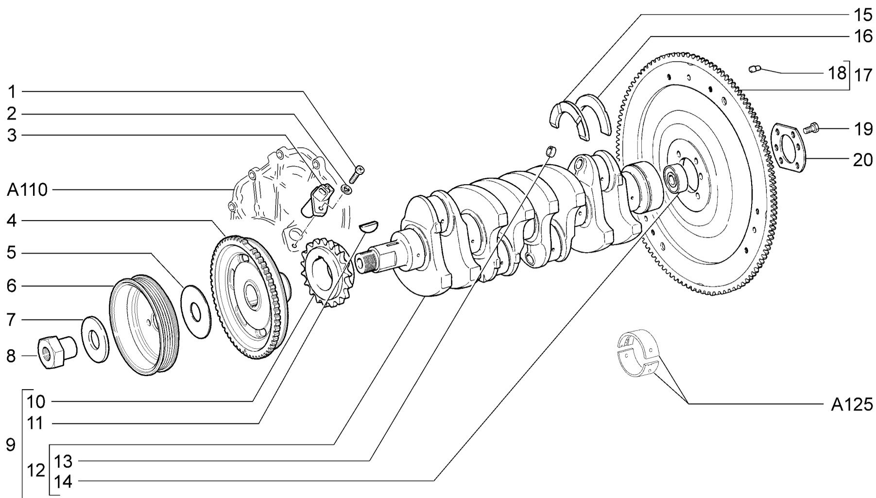
Вал коленчатый и маховик двигателя для автомобилей с КУ
