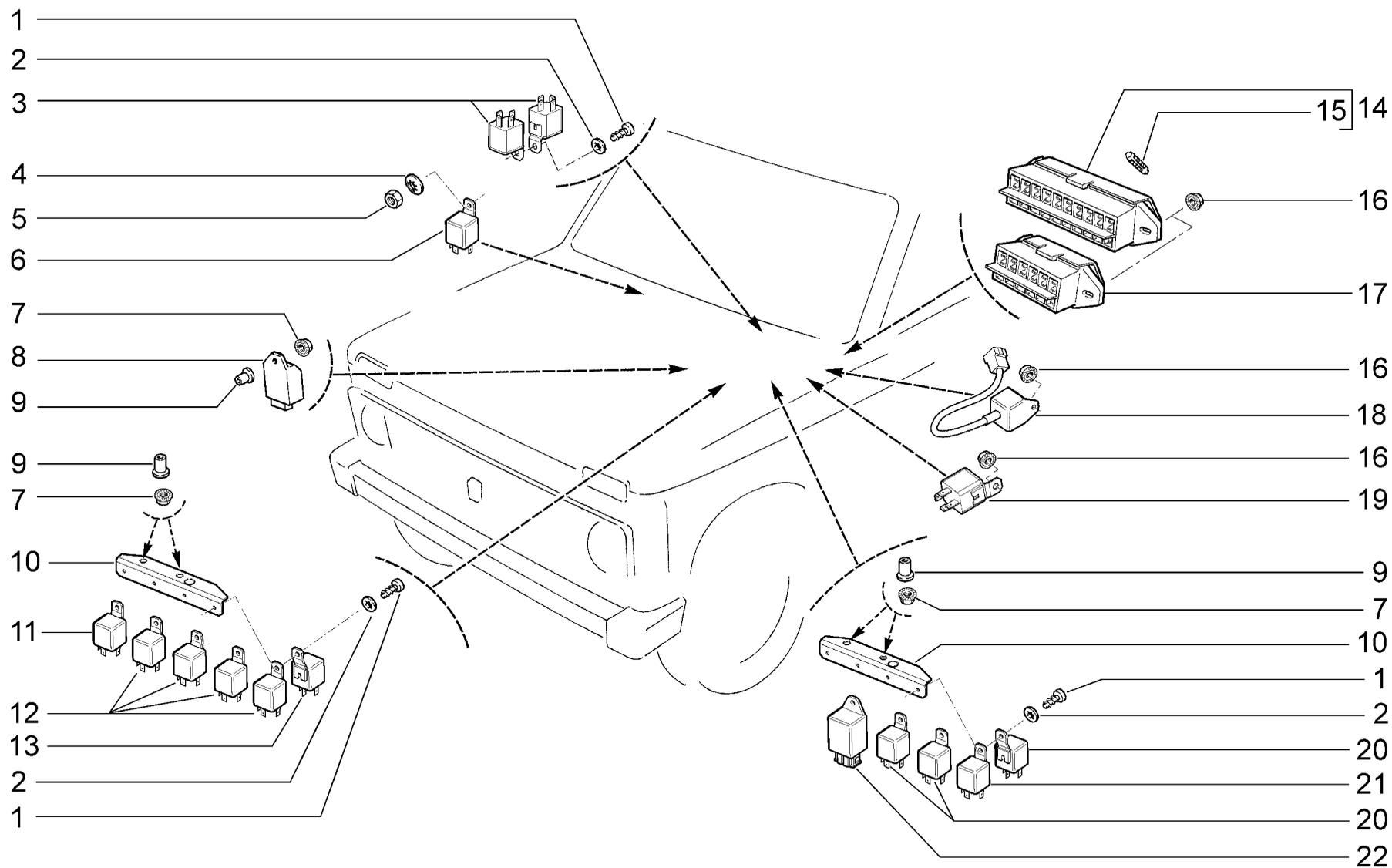
Реле и блоки предохранителей
