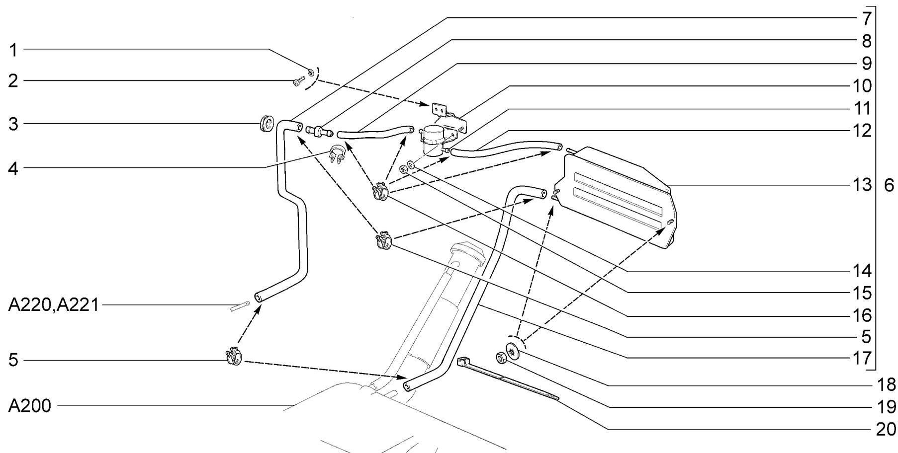
Система улавливания паров бензина (Сепаратор)
