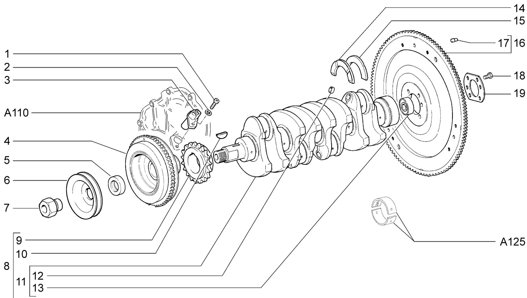
Вал коленчатый и маховик двигателя для автомобилей без КУ
