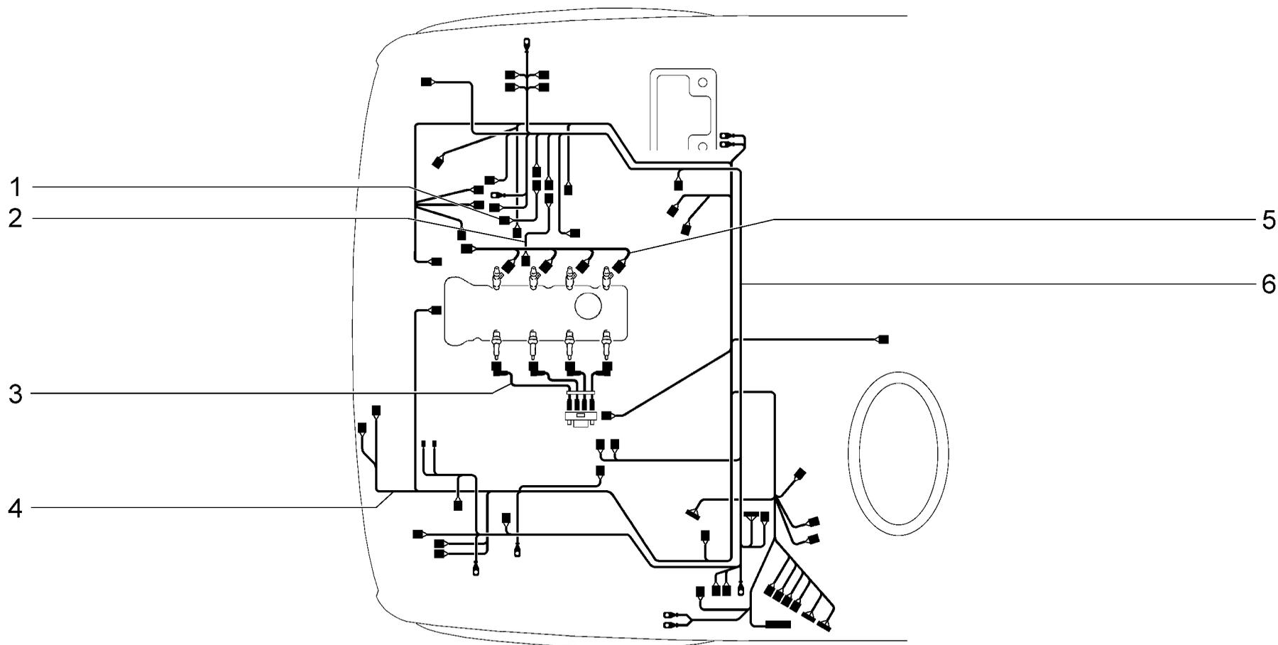
**Жгут проводов моторного отсека**
