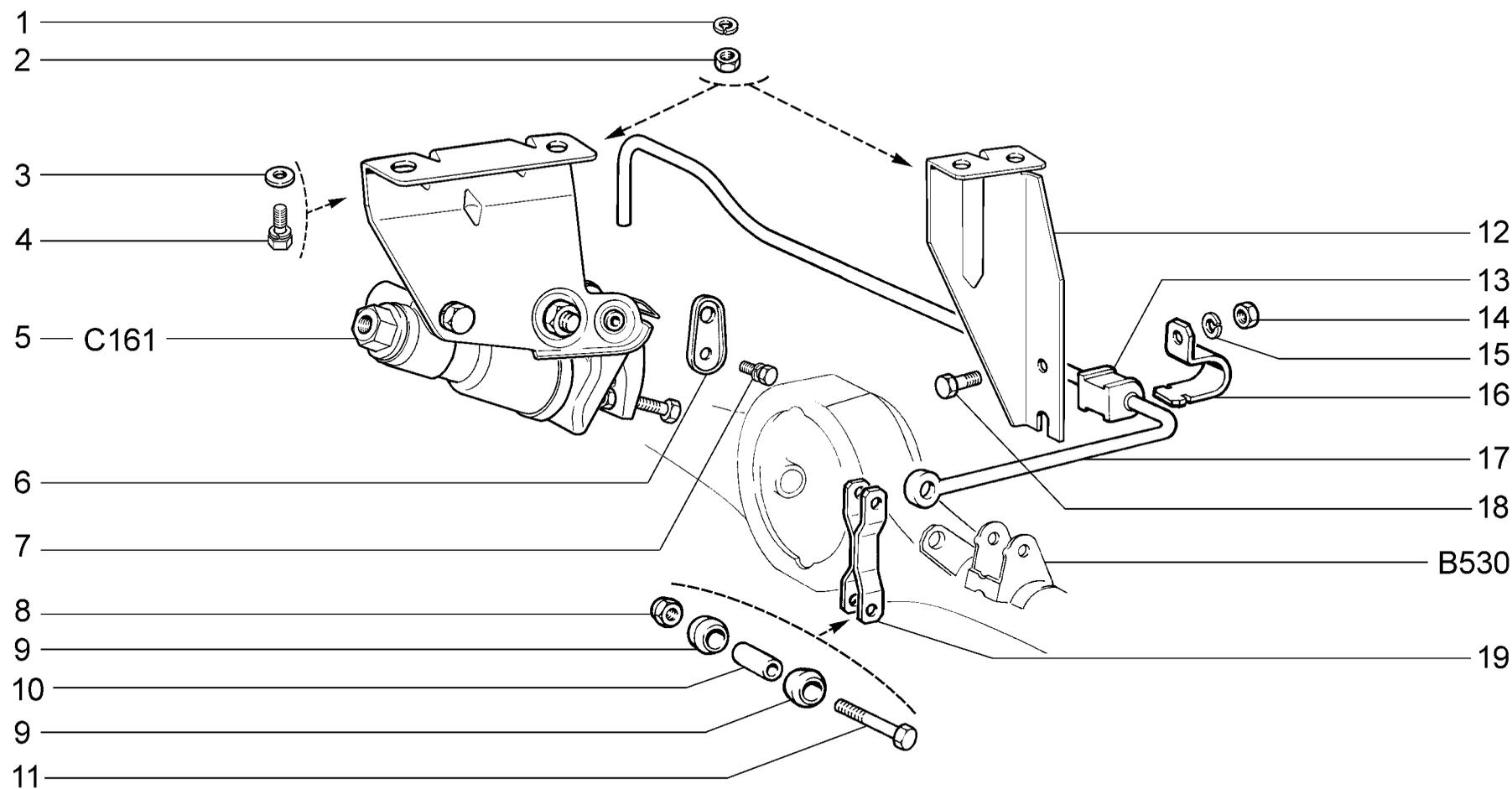
Привод регулятора давления
