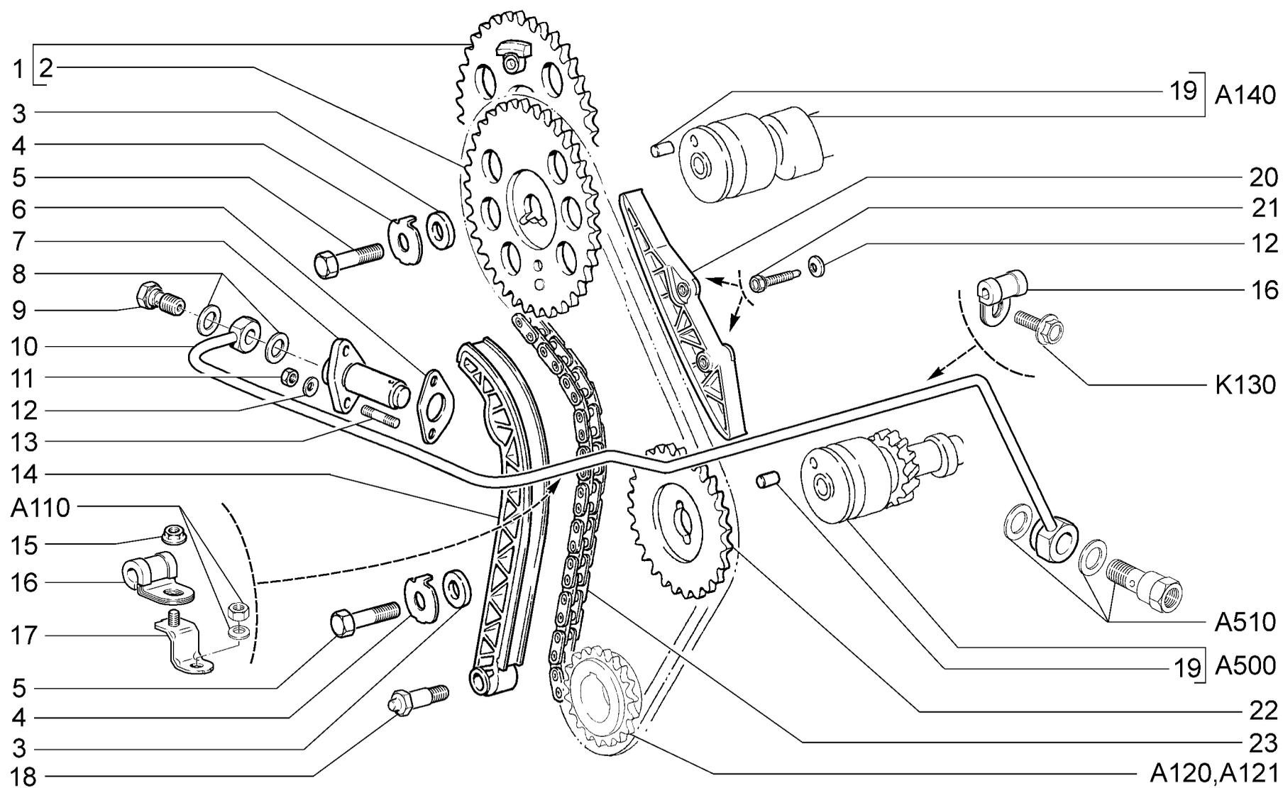
**Привод вала распределительного
