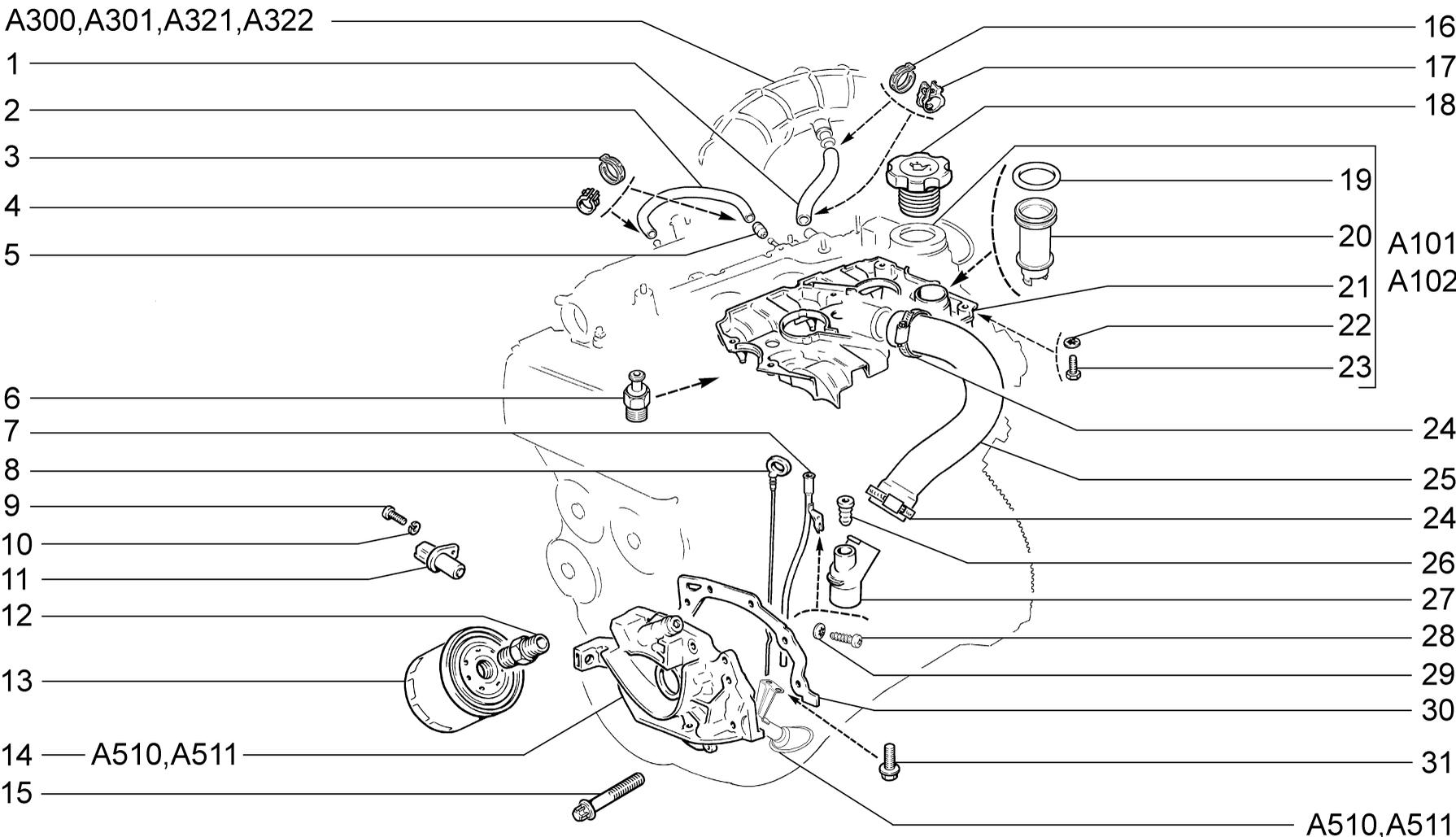
**СИСТЕМА СМАЗКИ И ВЕНТИЛЯЦИИ**
