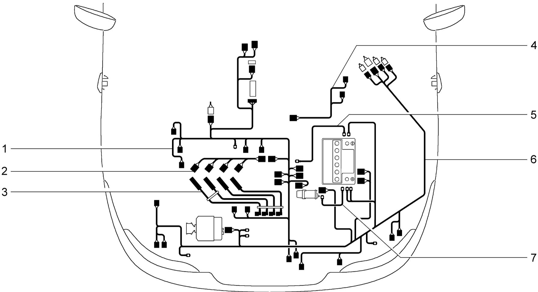
**ЖГУТЫ ПРОВОДОВ МОТОРНОГО ОТСЕКА**
