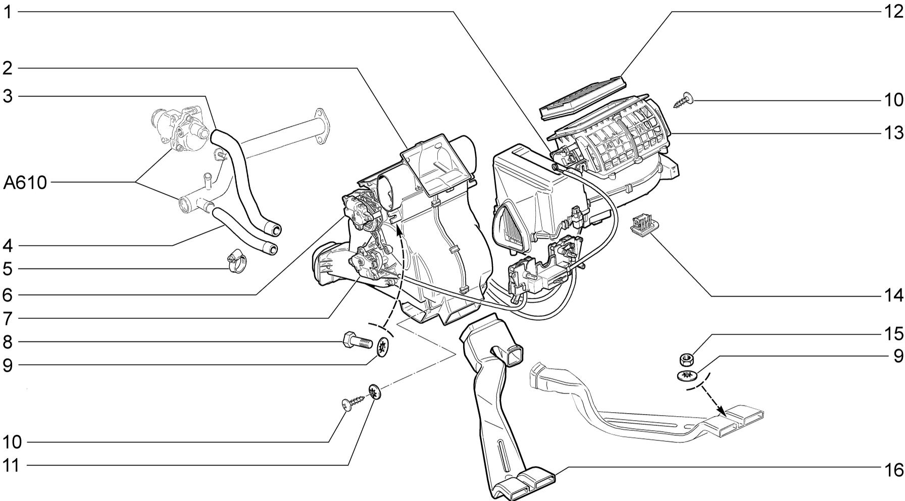
**СИСТЕМА ВЕНТИЛЯЦИИ И ОТОПЛЕНИЯ (КУ)**
