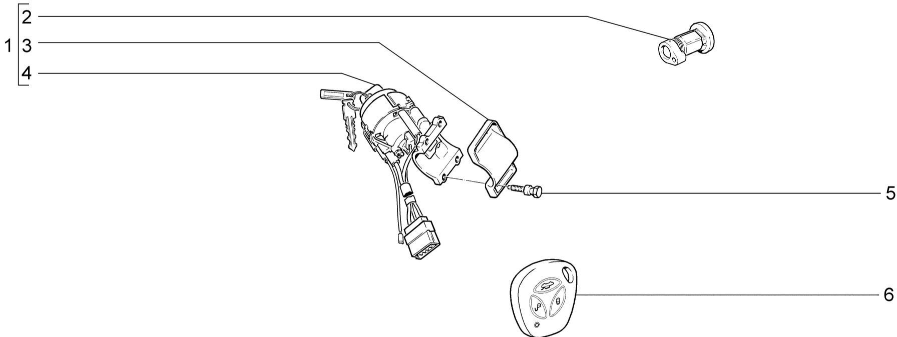
**ВЫКЛЮЧАТЕЛЬ ЗАЖИГАНИЯ С ВЫКЛЮЧАТЕЛЯМИ ЗАМКОВ ДВЕРЕЙ**
