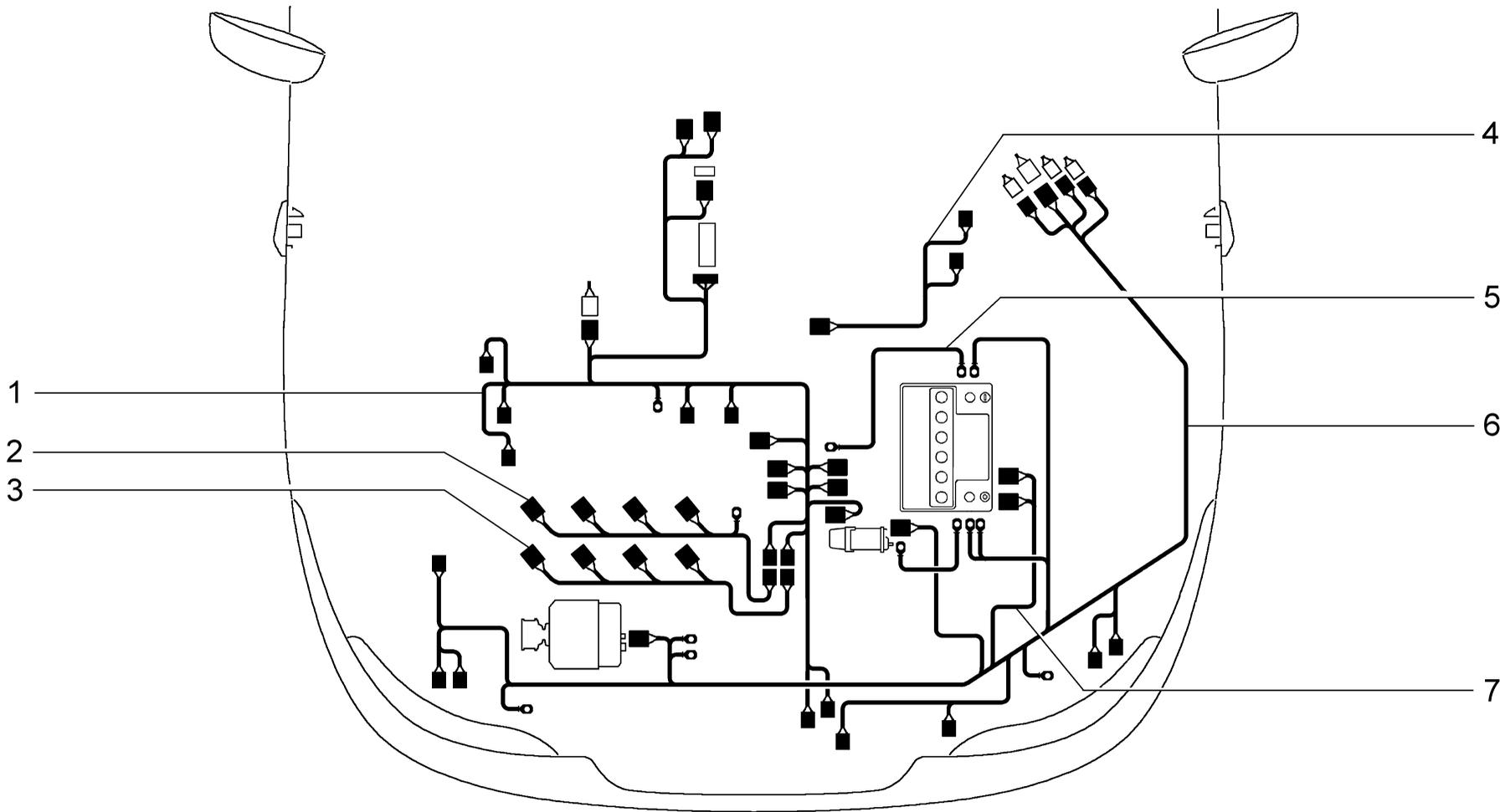
**ЖГУТЫ ПРОВОДОВ МОТОРНОГО ОТСЕКА**
