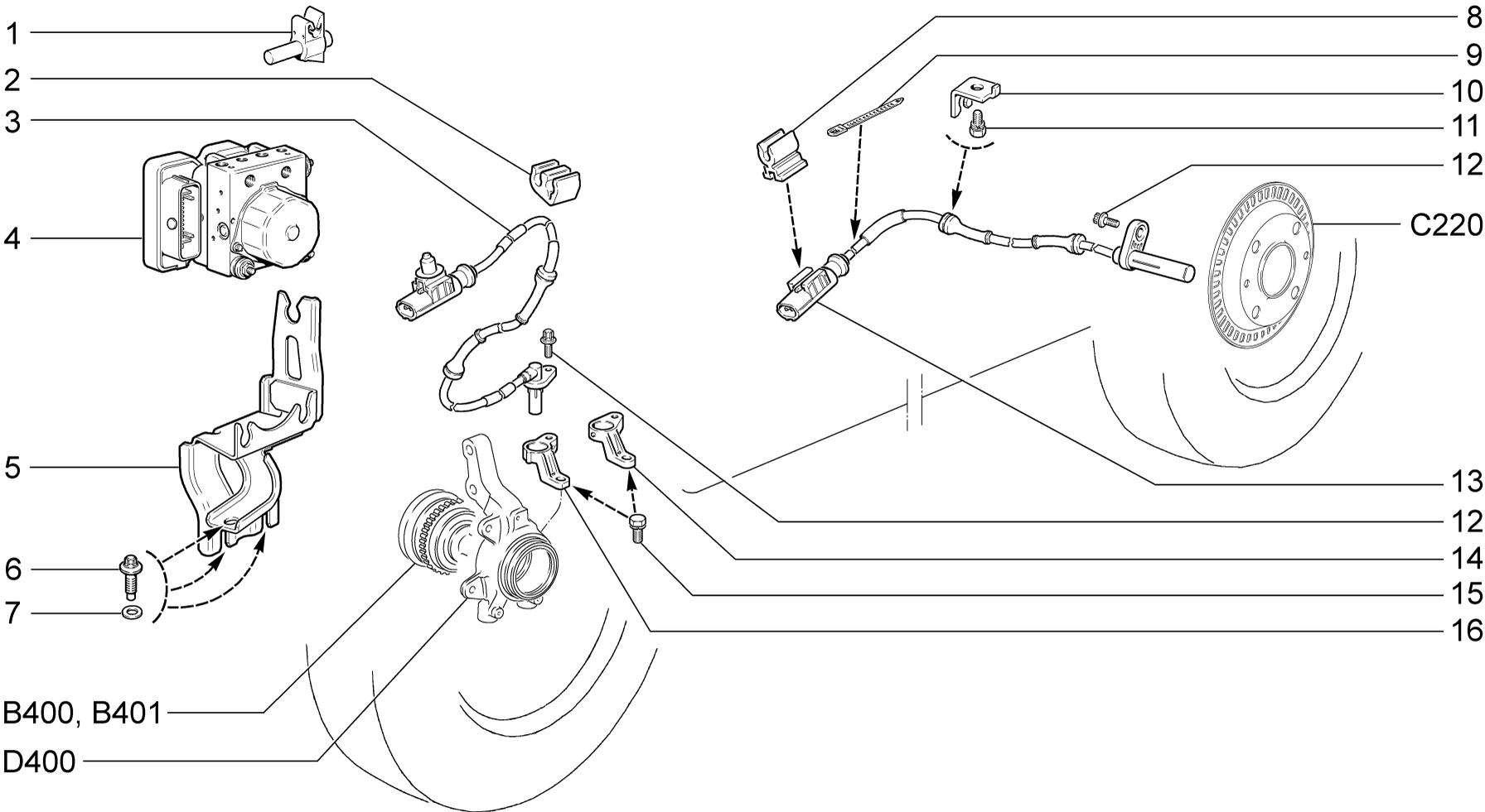
**ГИДРОАГРЕГАТ И ДАТЧИКИ СКОРОСТИ КОЛЁС (01-16,19) (02-11,12)**
