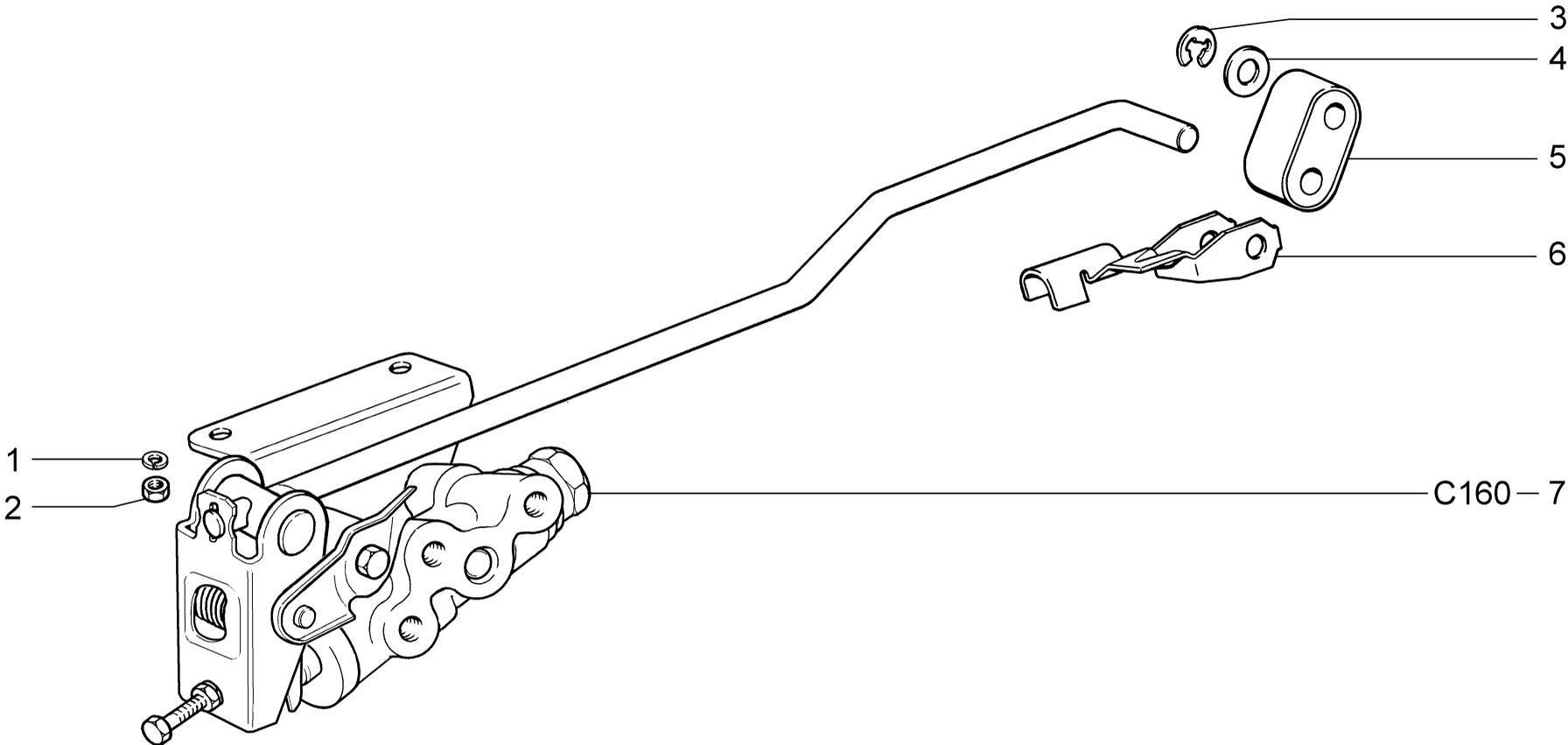
**ПРИВОД РЕГУЛЯТОРА ДАВЛЕНИЯ ТОРМОЗОВ**
