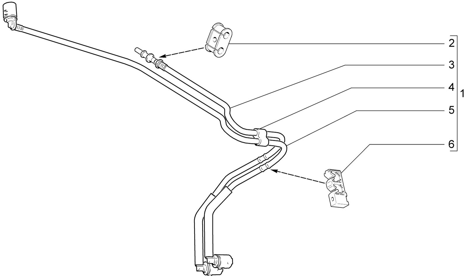
**ТРУБКИ ТОПЛИВНОГО И ПАРОВОГО ТРУБОПРОВОДОВ**
