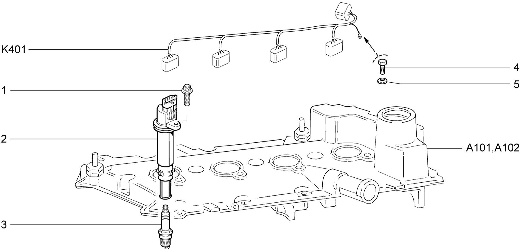
**МОДУЛИ И СВЕЧИ ЗАЖИГАНИЯ**
