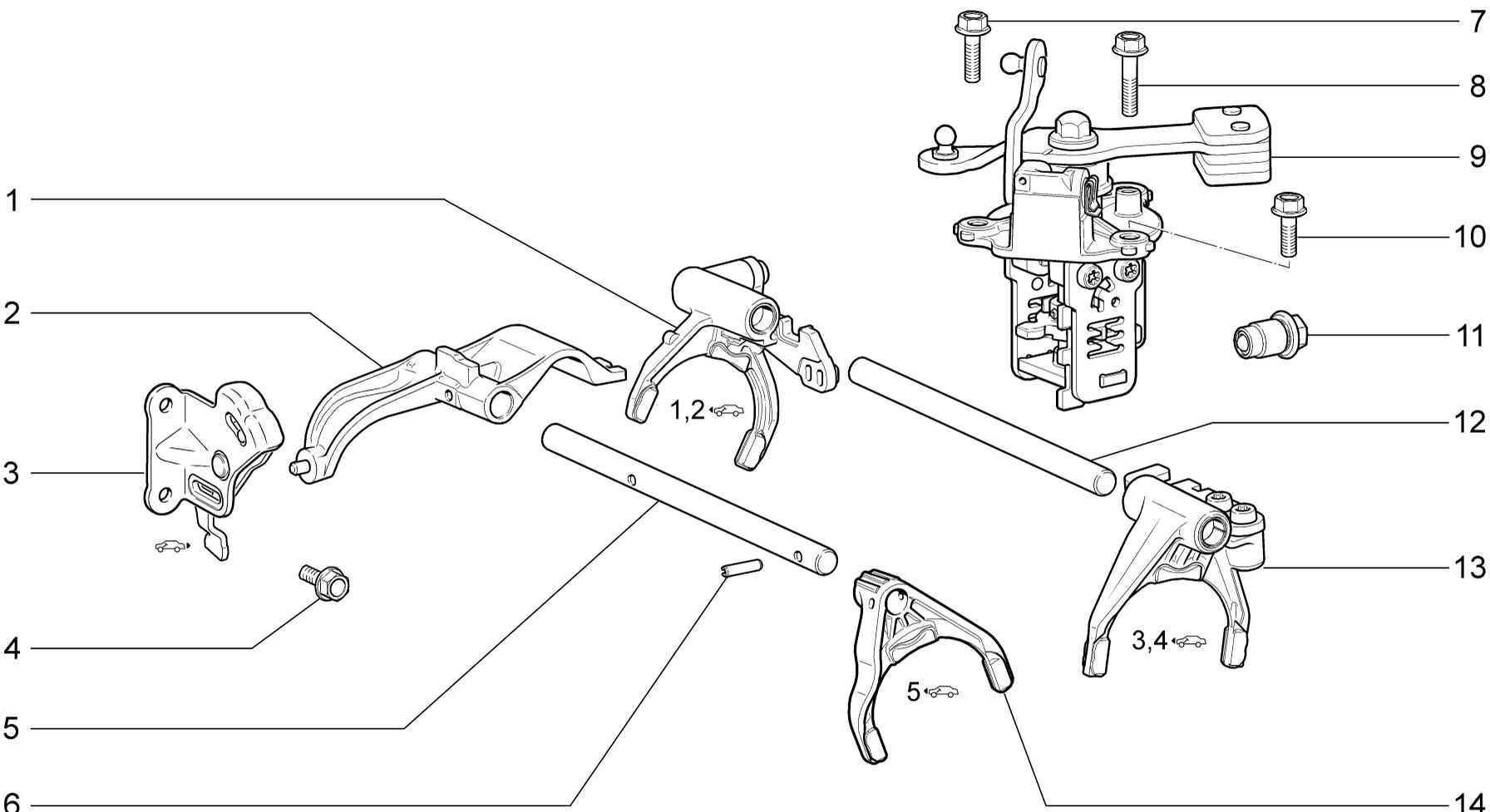
**МЕХАНИЗМ ПЕРЕКЛЮЧЕНИЯ ПЕРЕДАЧ (С10, С11)**
