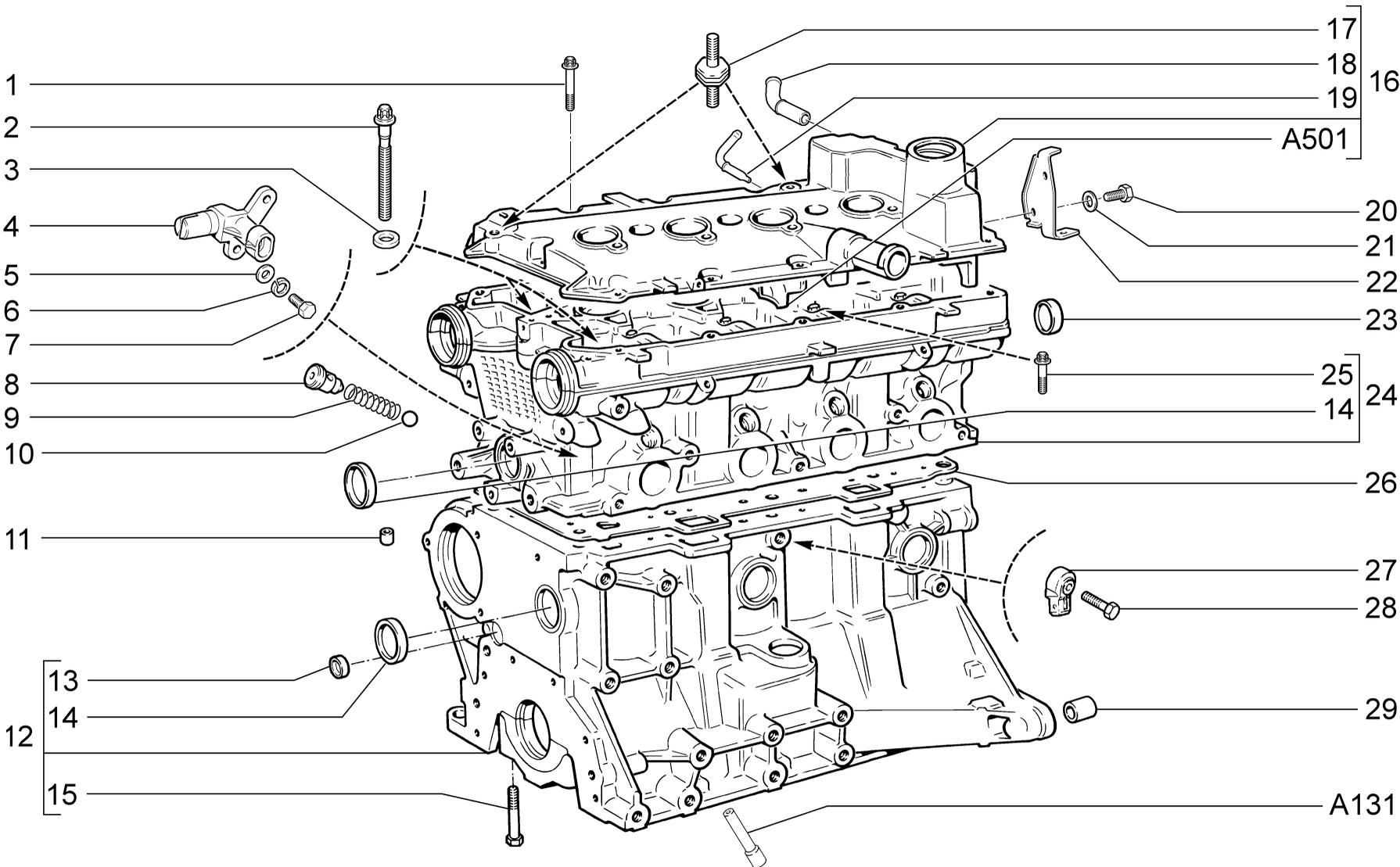
**БЛОК ЦИЛИНДРОВ И ГОЛОВКА БЛОКА**
