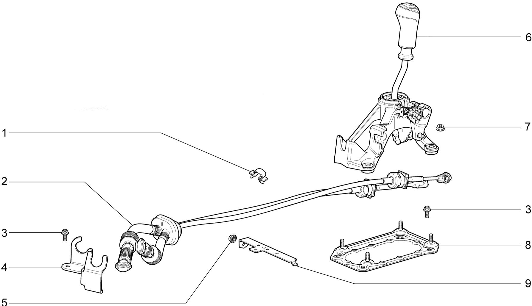
**ПРИВОД ПЕРЕКЛЮЧЕНИЯ ПЕРЕДАЧ**
