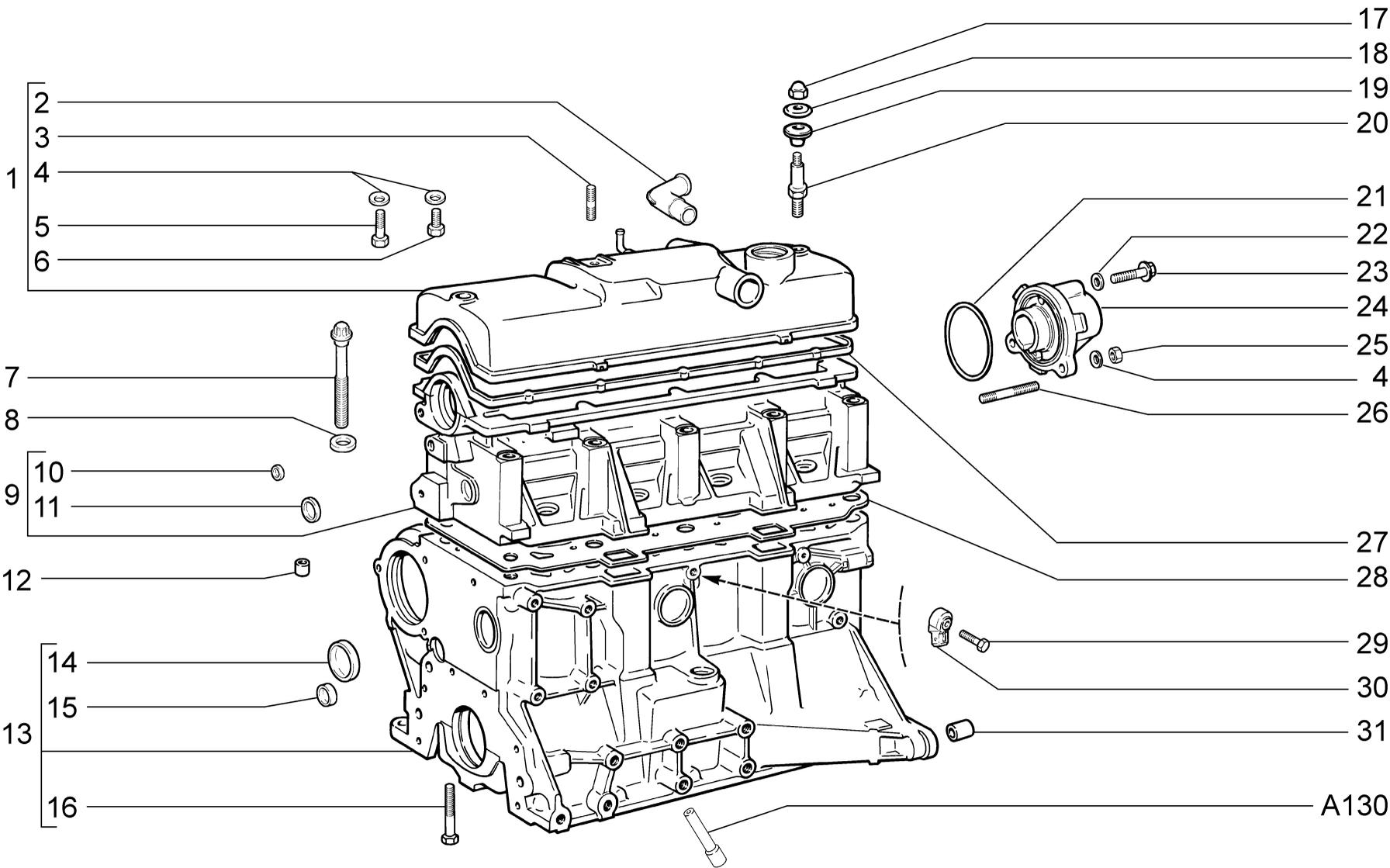
**БЛОК ЦИЛИНДРОВ И ГОЛОВКА БЛОКА**
