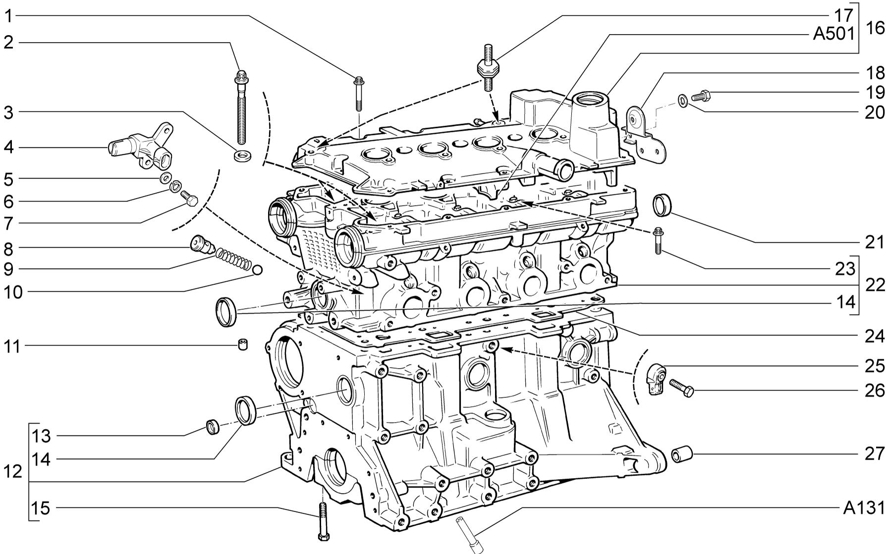
**БЛОК ЦИЛИНДРОВ И ГОЛОВКА БЛОКА**
