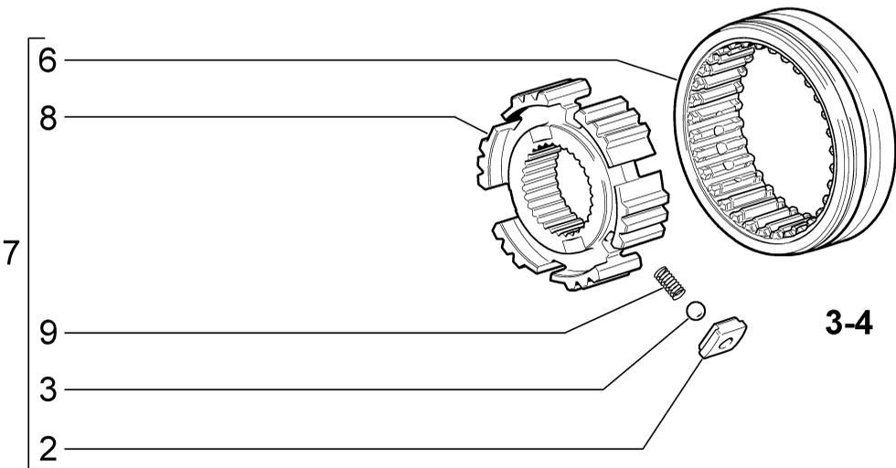
**СИНХРОНИЗАТОРЫ КОРОБКИ ПЕРЕДАЧ (С10, С11)**
