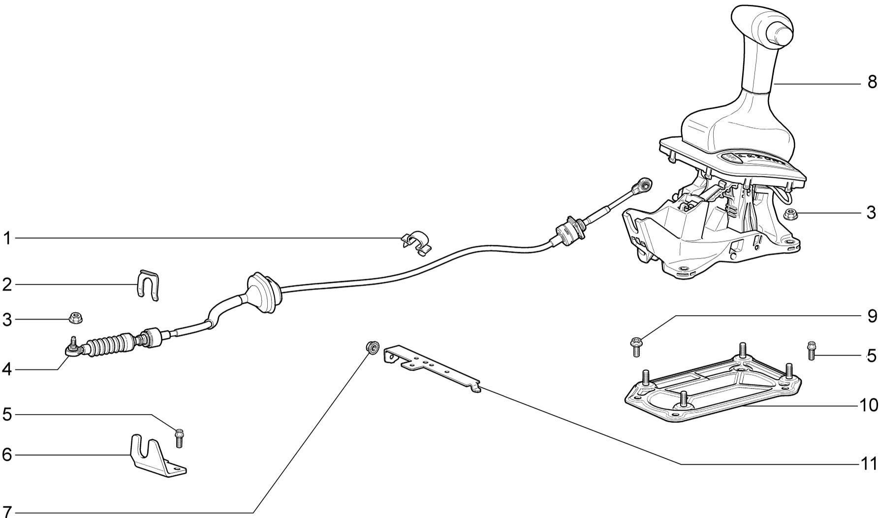
**ПРИВОД ПЕРЕКЛЮЧЕНИЯ ПЕРЕДАЧ**
