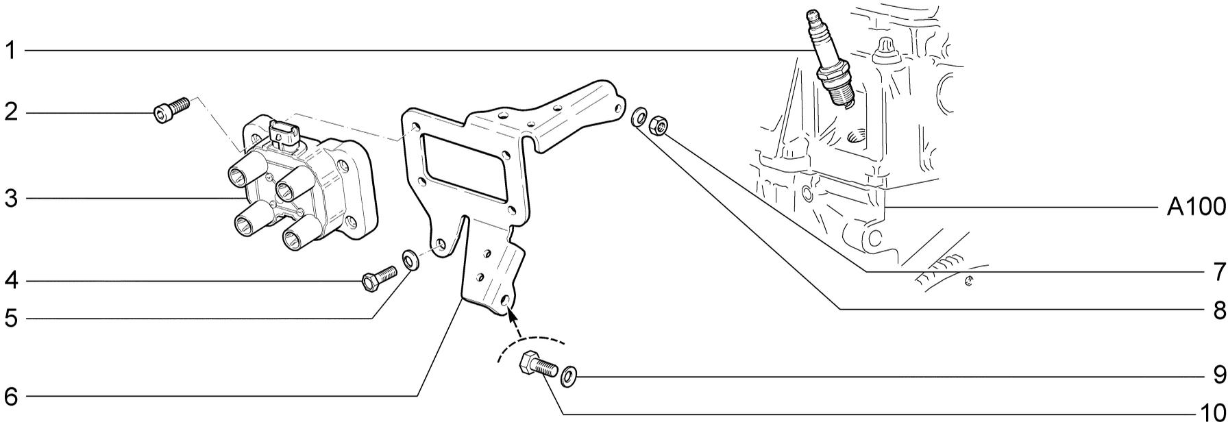
**КАТУШКА И СВЕЧИ ЗАЖИГАНИЯ**
