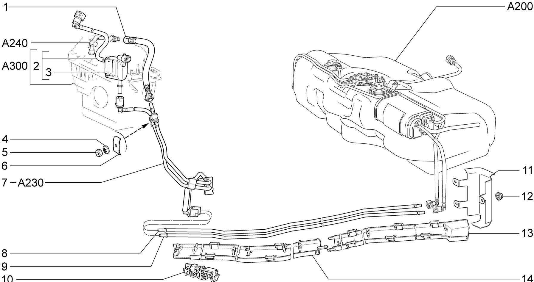
**ТРУБОПРОВОДЫ ТОПЛИВНЫЙ И ПАРОВОЙ**
