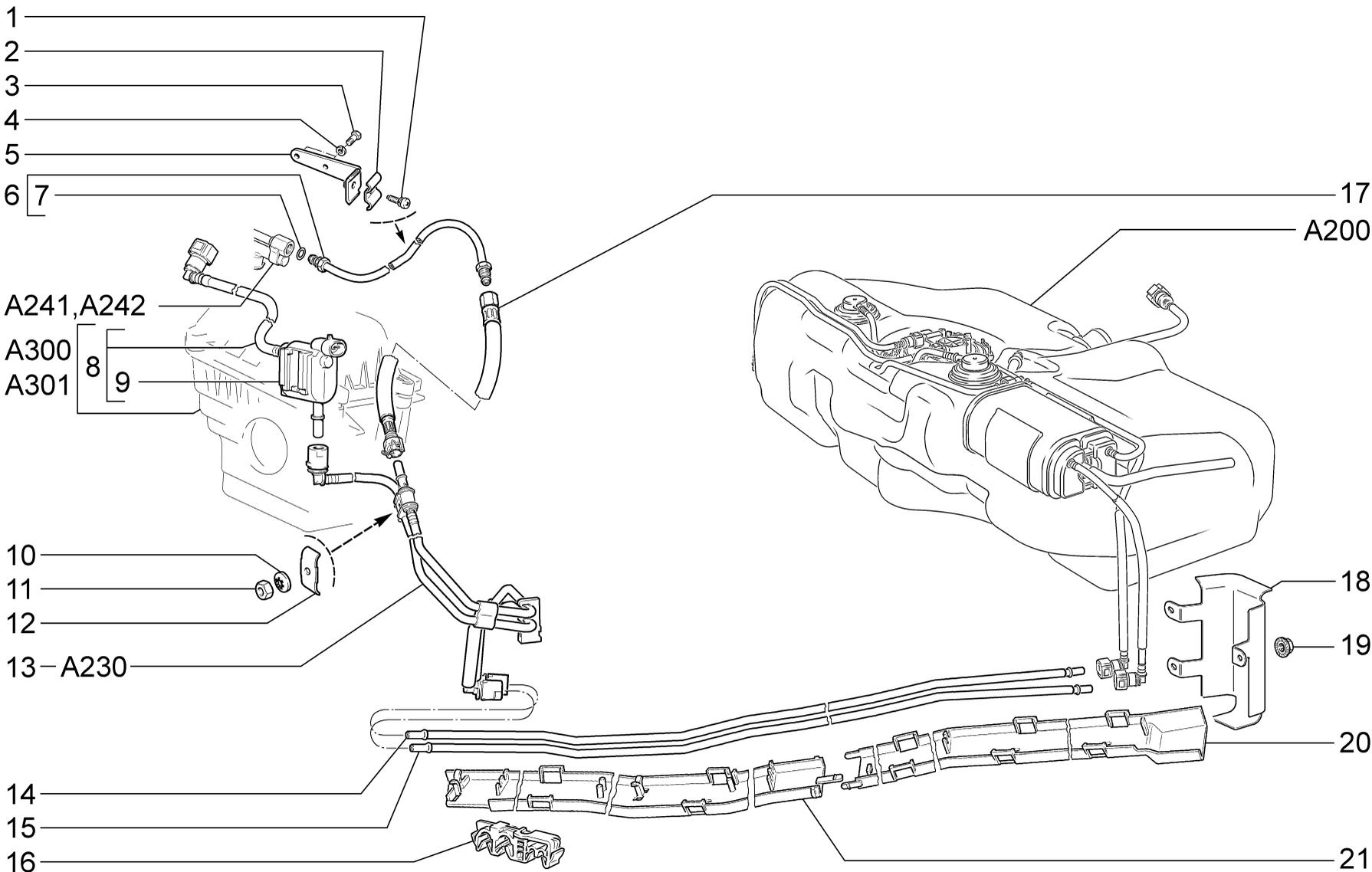
**ТРУБОПРОВОДЫ ТОПЛИВНЫЙ И ПАРОВОЙ**
