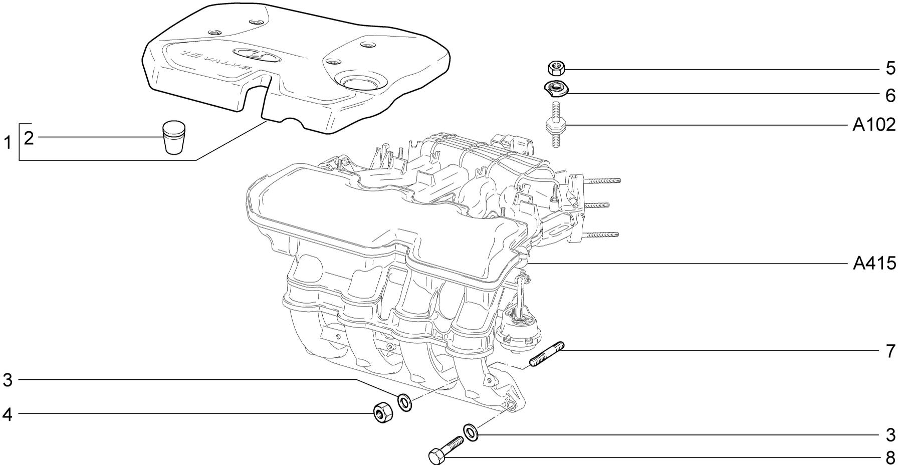
**УСТАНОВКА МОДУЛЯ ВПУСКА**
