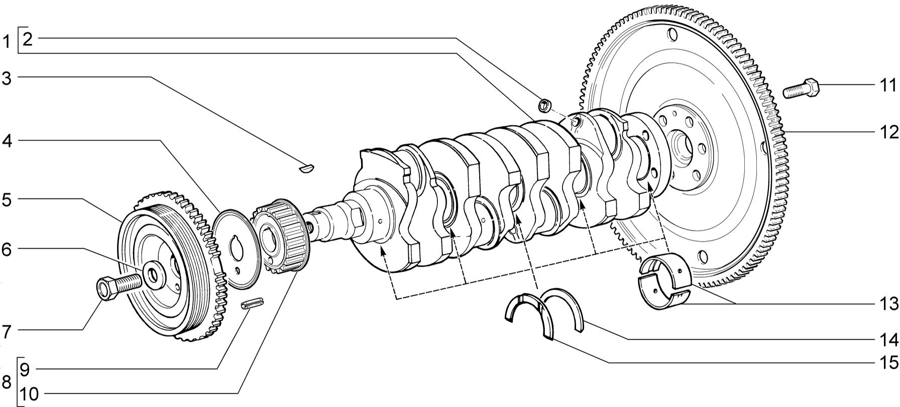
**ВАЛ КОЛЕНЧАТЫЙ И ДИСК ПРИВОДНОЙ**
