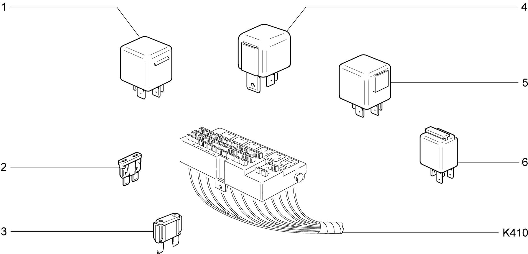
**РЕЛЕ МОНТАЖНОГО БЛОКА**
