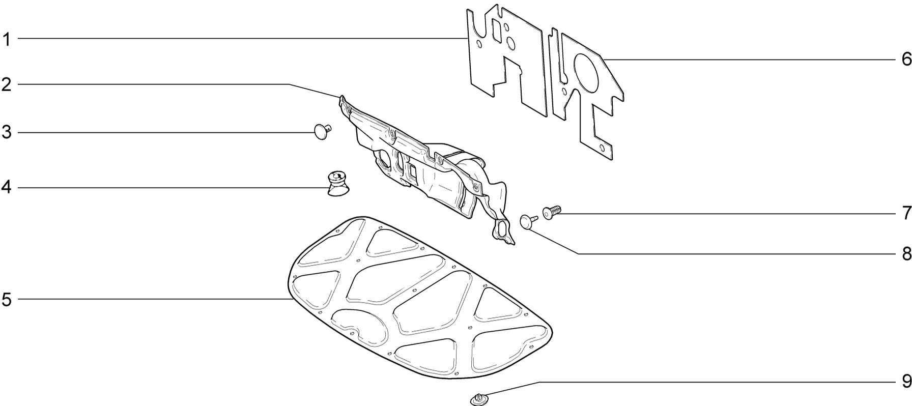
**ШУМОИЗОЛЯЦИЯ МОТОРНОГО ОТСЕКА**
