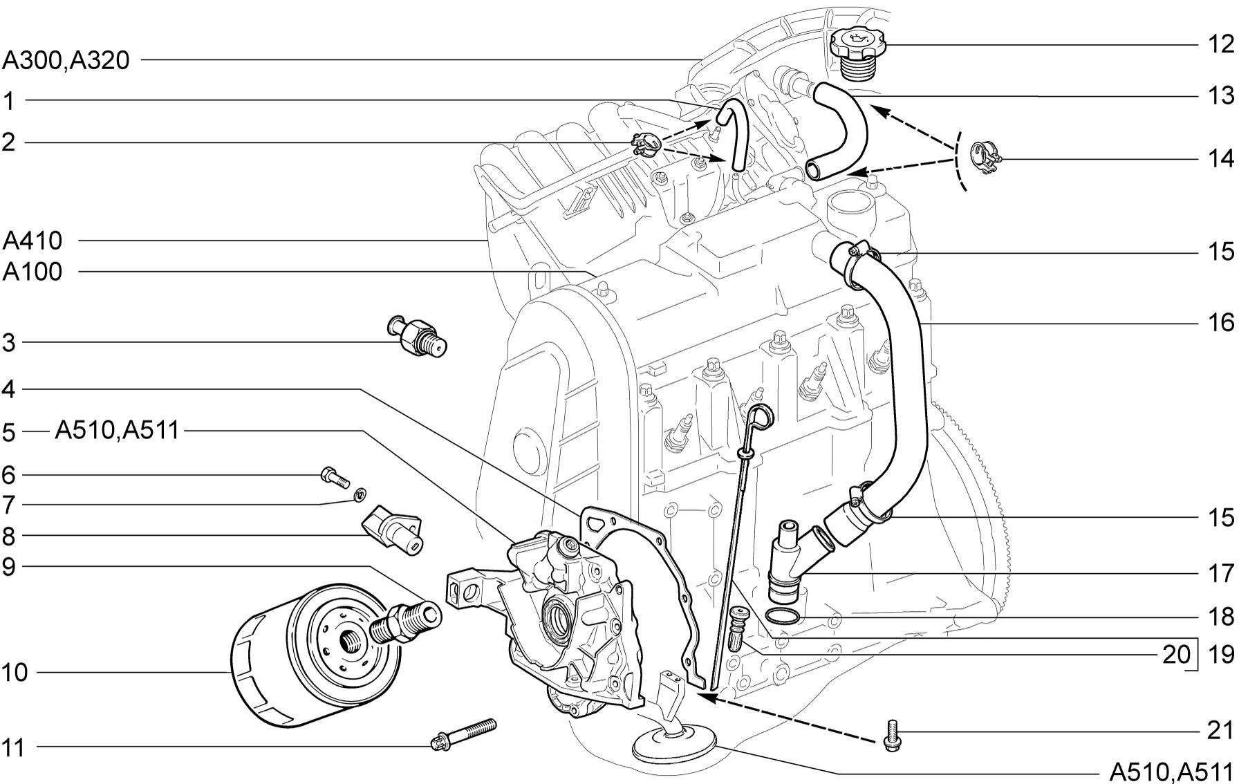
**СИСТЕМА СМАЗКИ И ВЕНТИЛЯЦИИ**
