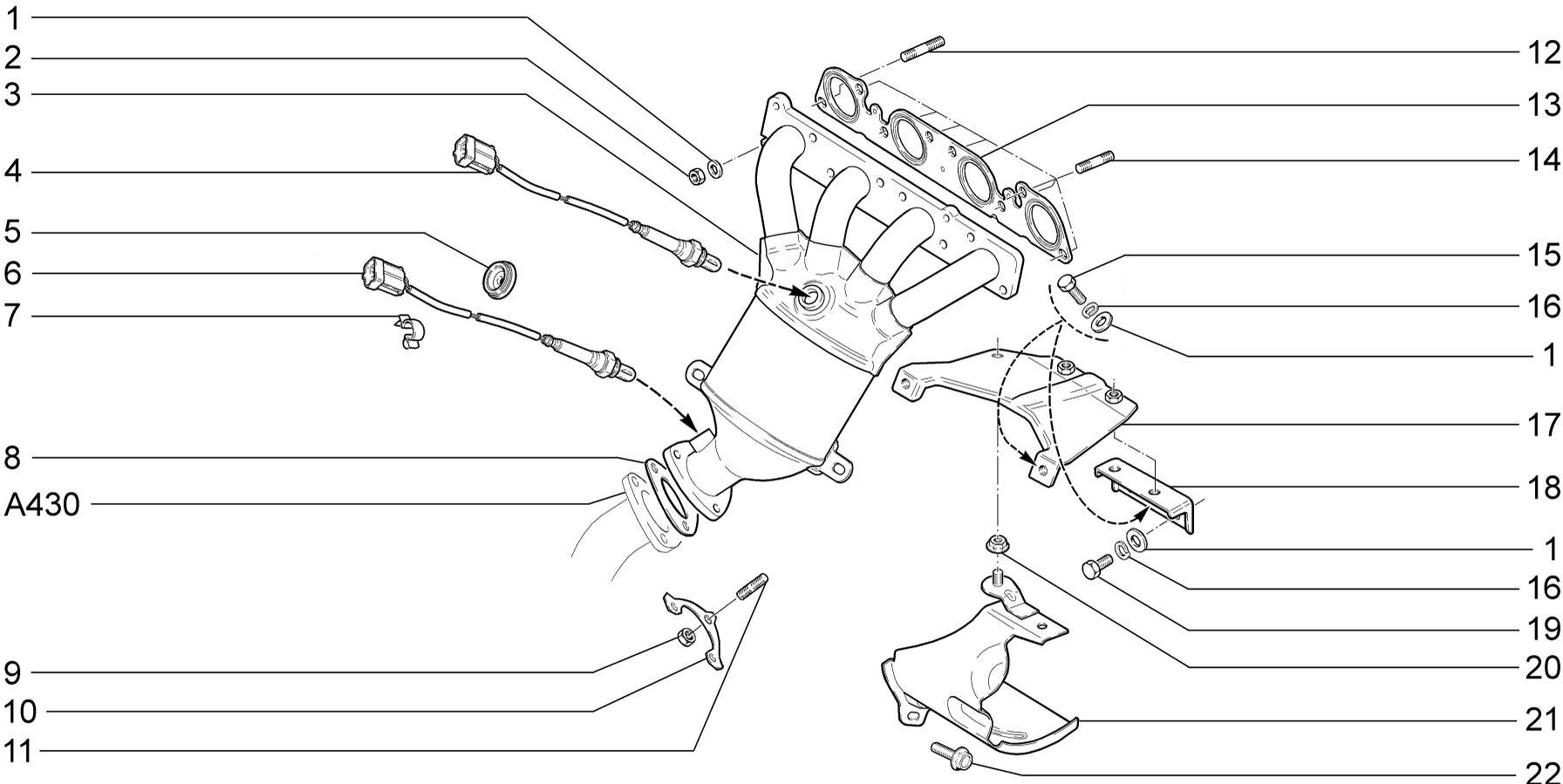
**ТРУБА ПРИЕМНАЯ С НЕЙТРАЛИЗАТОРОМ**
